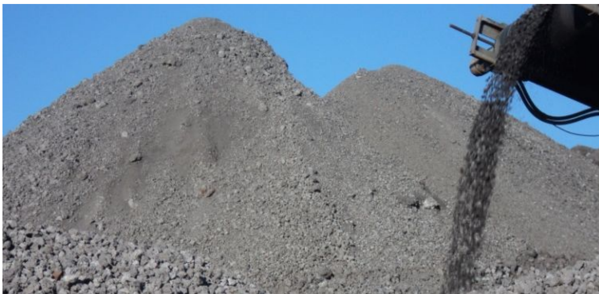
Slika 7. Prikaz crne troske iz procesa proizvodnje ugljičnih čelika elektrolučnim postupkom [15].
