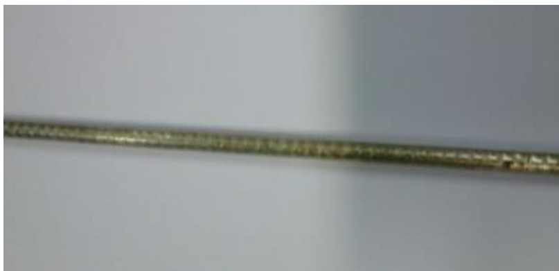
Slika 20. Fotografija kontinuirano lijevane cilindrične šipke Cu-Al-Mn legure promjera 8 mm
