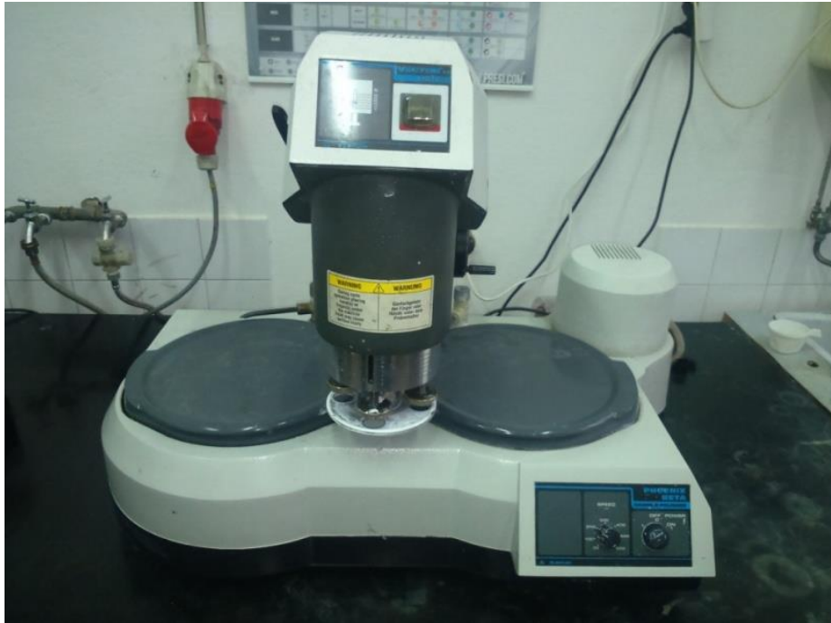
Slika 15. Fotografija uređaja PHOENIX BETA za metalografsku pripremu
