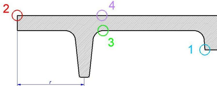
Slika 29. Položaji na poklopcu praćenih numeričkih rezultata ekvivalentnih naprezanja
