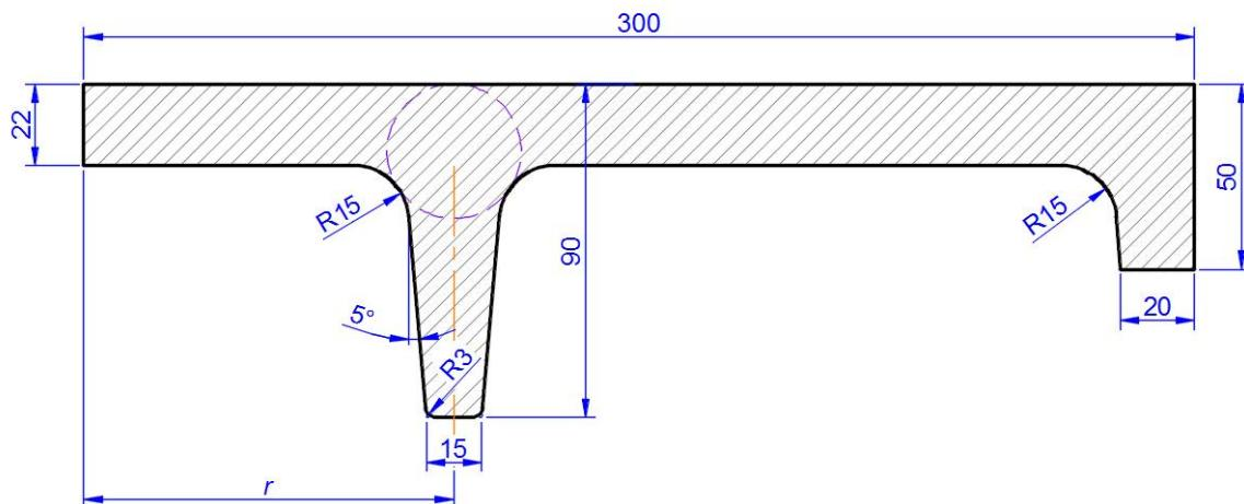
Slika 4. Geometrija osnog presjeka kanalskog poklopca
