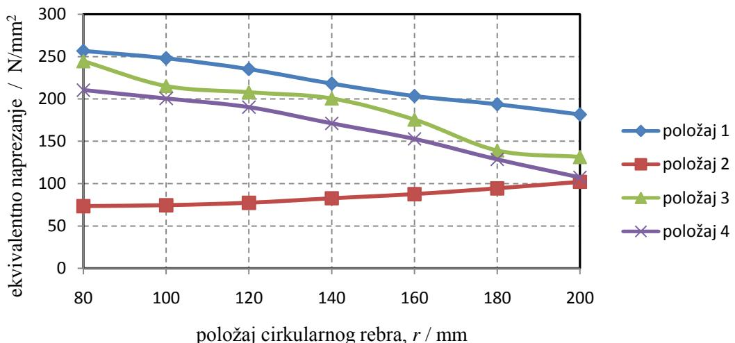
Slika 30. Dijagram ovisnost ekvivalentnih naprezanja o položaju cirkularnog rebra na poklopcu
