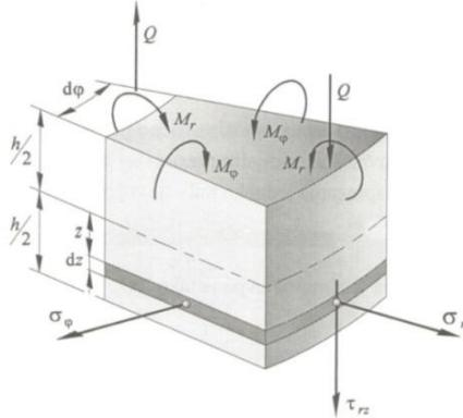
Slika 12. Komponente naprezanja i unutarnjih sila [18]
