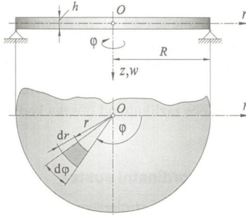
Slika 11. Cilindrični koordinatni sustav na kružnoj ploči [18]
