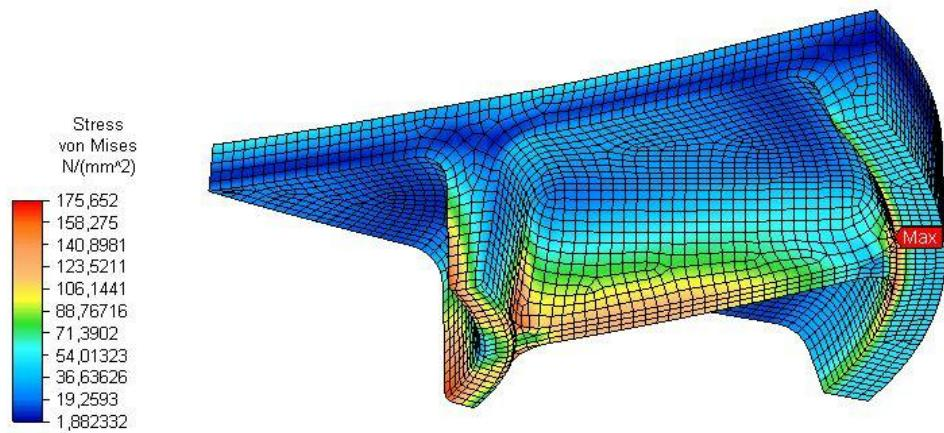
Slika 36. Numerički rezultati ekvivalentnih naprezanja na poklopcu(varijanta III)
