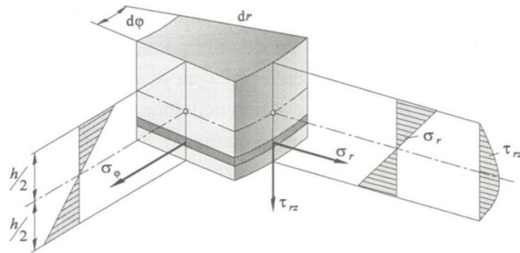
Slika 14. Raspodjela komponenata naprezanja  $\sigma_r$ ,  $\sigma_\phi$  i  $\tau_{rz}$  na elementu kružne ploče [12]
