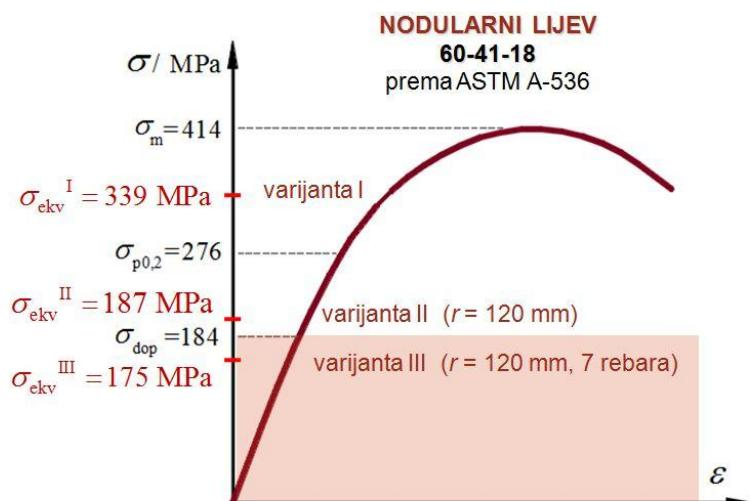
Slika 37. Usporedba postizanja uvjeta čvrstoće za nodularni lijev (kvalitete 60-41-18 prema ASTM A-536) za sve tri odabранe analize varijanti poklopca (I, II i III)
