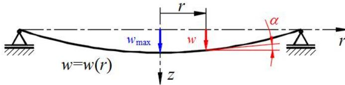
Slika 13. Elastična linija tanke ploče opterećene na savijanje
