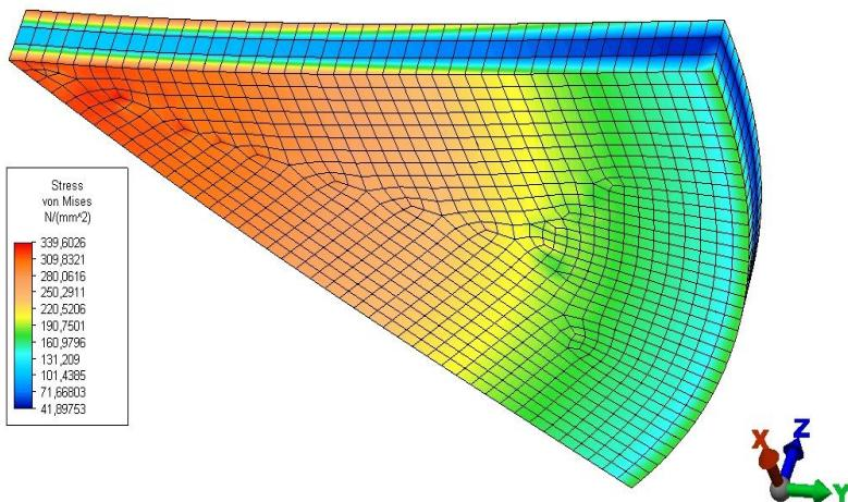
Slika 25. Prikaz rezultata ekvivalentnih naprezanja tanke kružne ploče [8]
