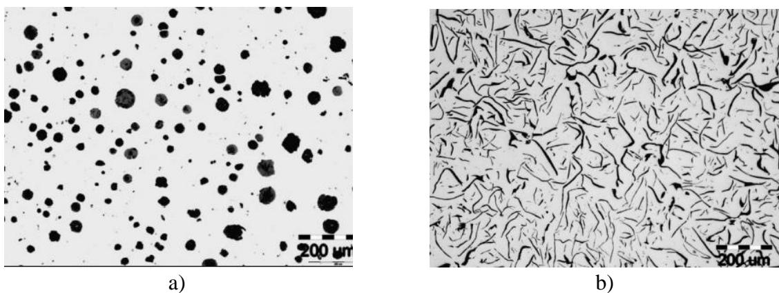
Slika 9. Mikrostruktura u nenagrzenom stanju [13]: a) nodularni lijev, b) sivi lijev
