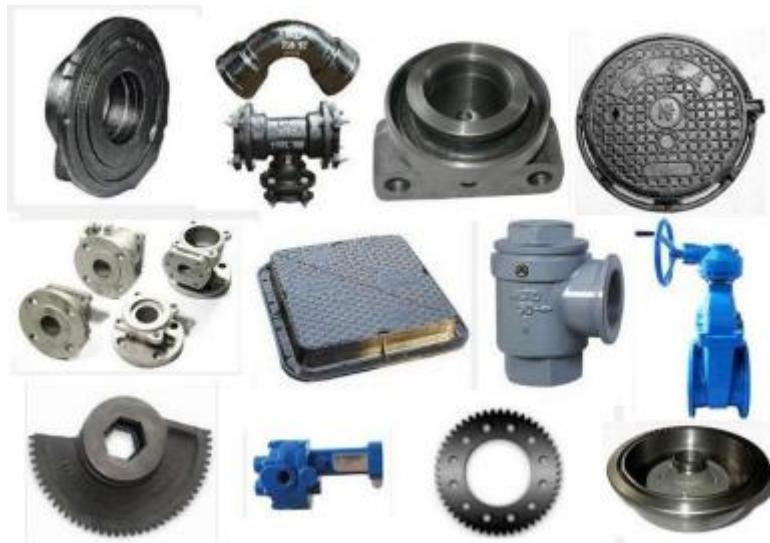
Slika 10. Primjerci odljevaka nodularnog lijeva [14].
