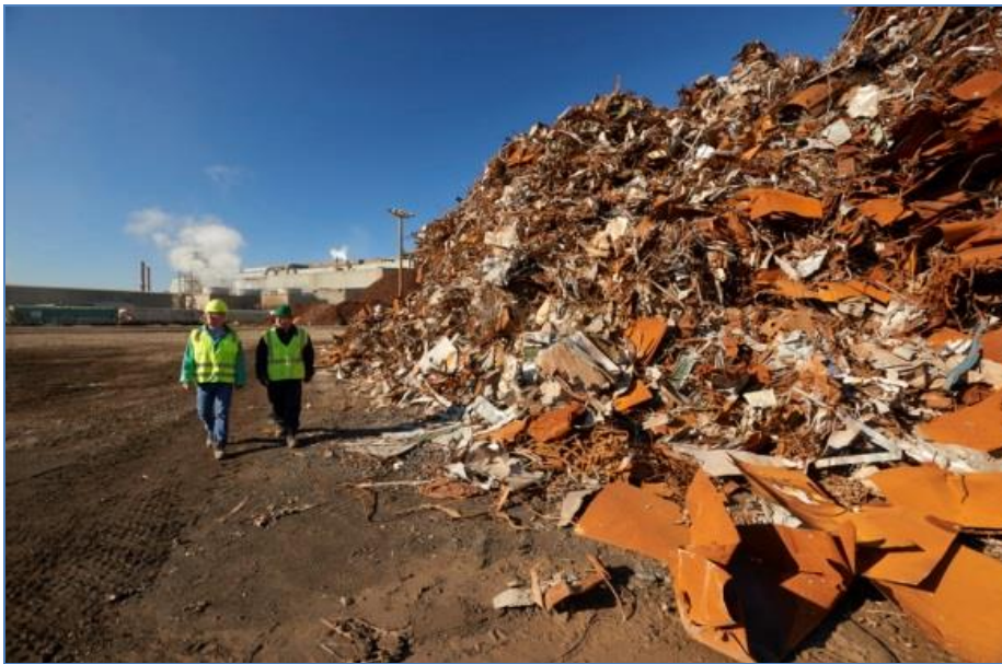
Slika 4. Skladištenje čeličnog otpada na nezaštićenoj zemljanoj površini [20]
