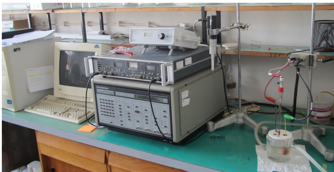
Slika 44. Aparatura za provedbu elektrokemijskih ispitivanja
