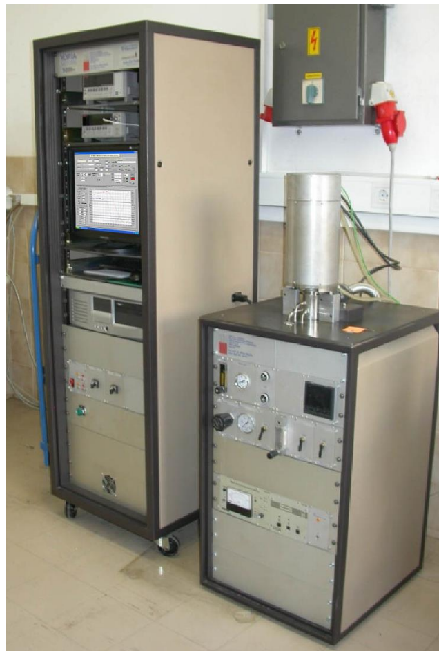
Slika 37. Fotografija aparature za mjerenje električnog otpora uzoraka
