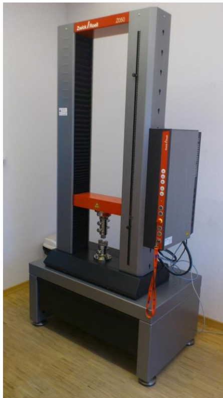
Slika 40. Fotografija kidalice Zwick/Roell Z050
