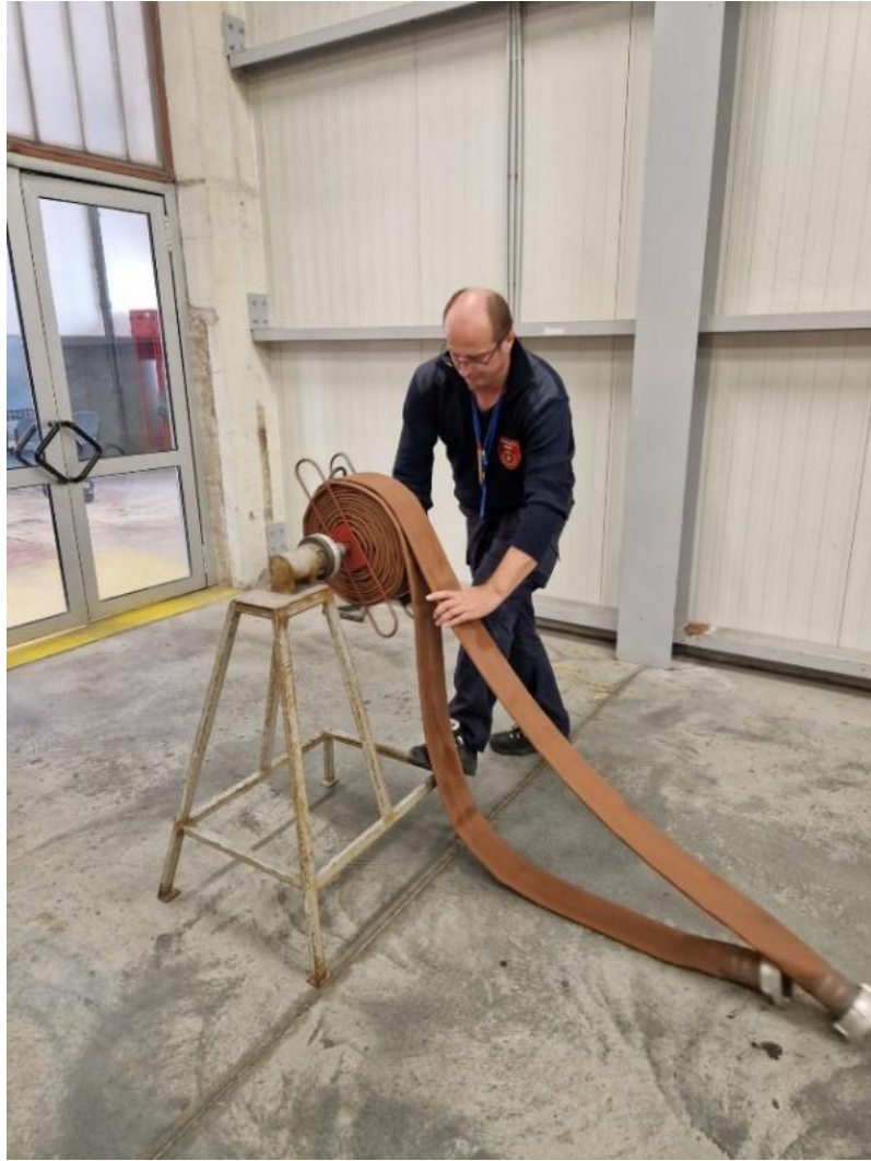
Slika 31. Uređaj za namatanje tlačnih cijevi
