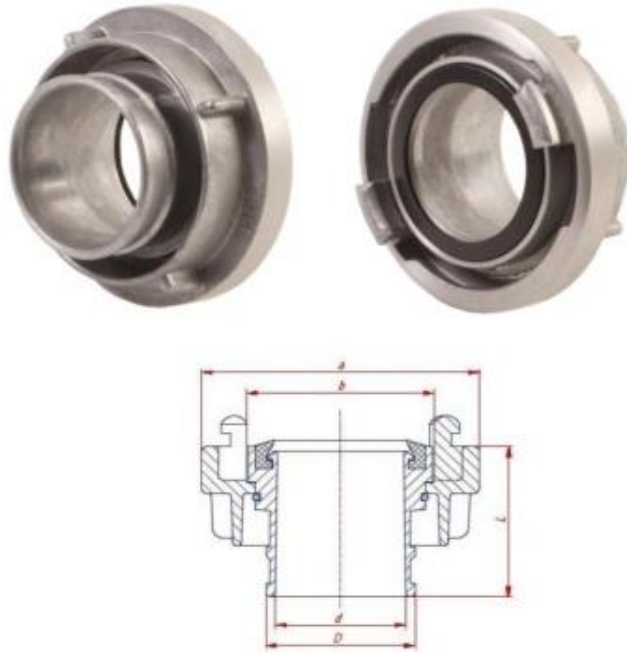
Slika 7. „Storz“ ili bespolna vatrogasna spojnicica [6]
