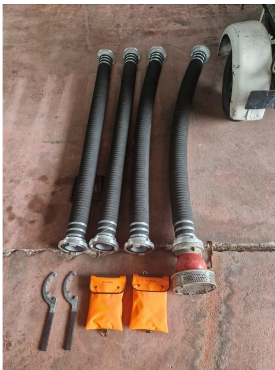
Slika 3. Oprema za postavljanje usisnog voda
