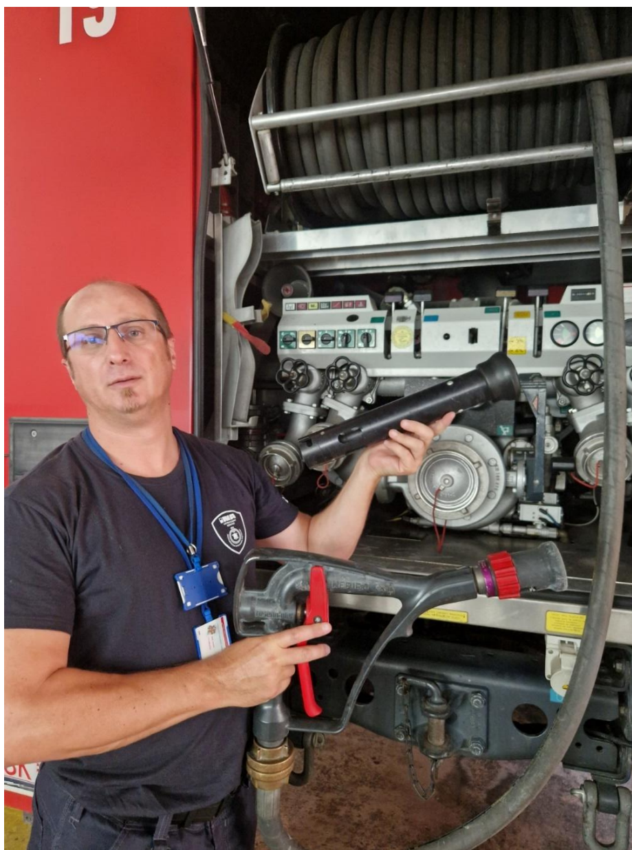
Slika 12. Vitlo za brzu navalu s mlaznicom za vodu i nastavkom za dobivanje pjene
