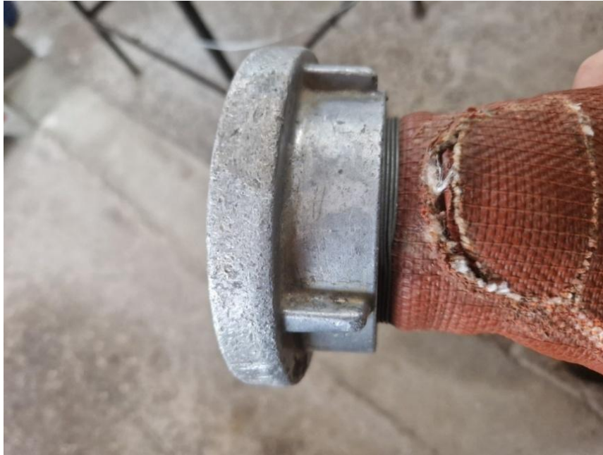
Slika 42. Oštećenje tlačne cijevi uslijed prelaska kamiona preko tlačne cijevi pod tlakom blizu spojnice
