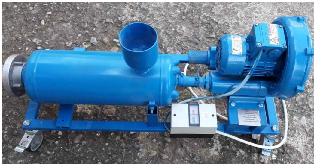
Slika 20. Uređaj za talkiranje vatrogasnih cijevi
