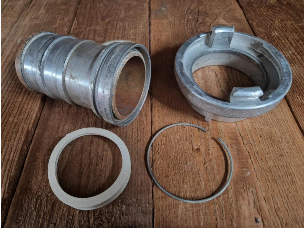
Slika 17. Sastavni dijelovi "Storz" vatrogasne spojnice
