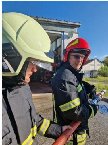
Slika 48. Provjera tlaka u ispitivanoj cijevnoj pruzi
