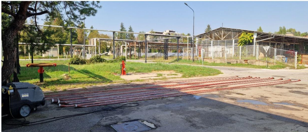
Slika 45. Sušenje tlačnih cijevi prije ispitivanja
