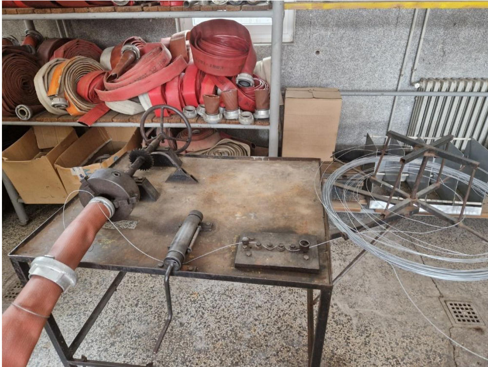
Slika 18. Uređaj za vezivanje vatrogasnih Storz spojnice
