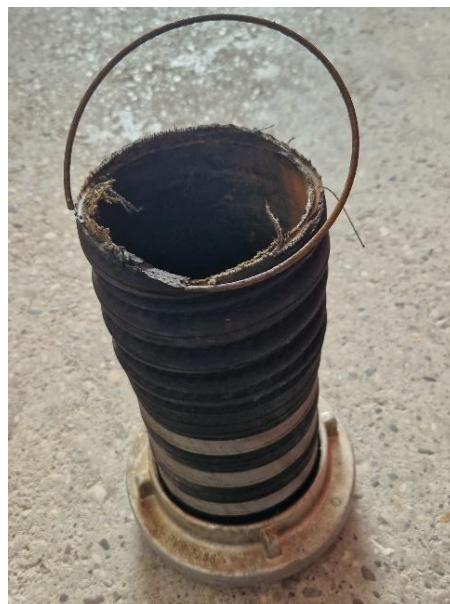
Slika 5. Presjek usisne cijevi
