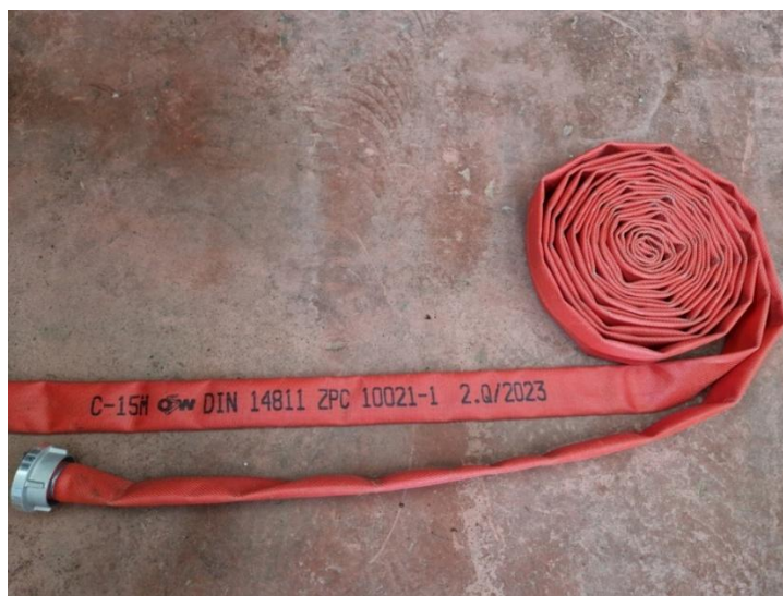
Slika 23. Oznake na tlačnim cijevima
