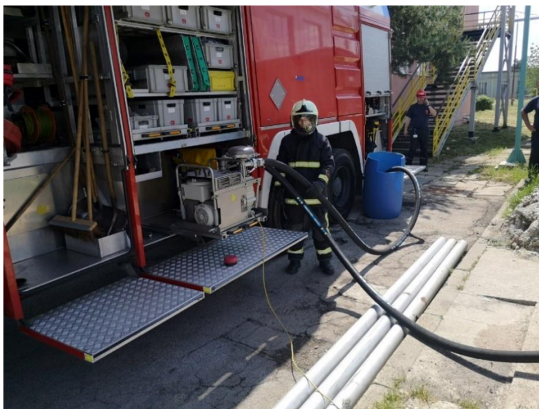
Slika 28. Pretakanje zapaljivih tekućina
