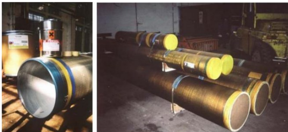
Slika 25. Privremena zaštita unutrašnjosti cijevi s praškastim inhibitorima korozije [42]
