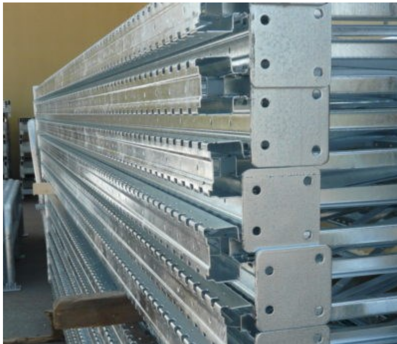
Slika 15. Proizvodi zaštićeni metodom vrućeg pocinčavanja [22]
