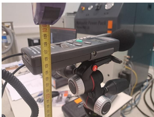
Slika 49 Postavljanje mikrofona na prihvatljivu visinu
