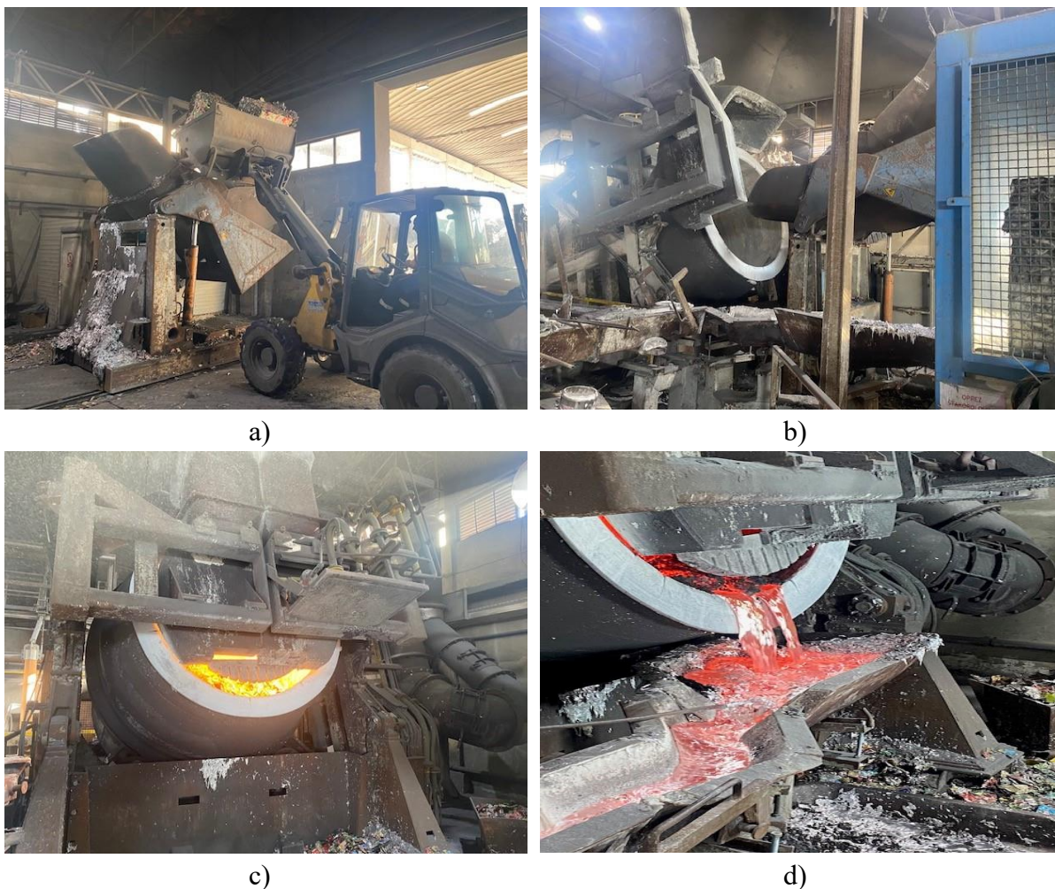
Slika 15. Taljenje sirovine: a) punjenje kolica za šaržiranje, b) ulaganje sirovine u peć za taljenje, c) peć za taljenje, d) prelijevanje u peć za legiranje
