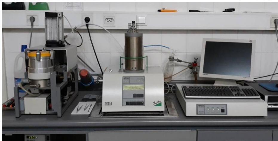
Slika 69. Uređaj Netzsch STA449 C Jupiter za provođenje diferencijalne pretražne kalorimetrije
