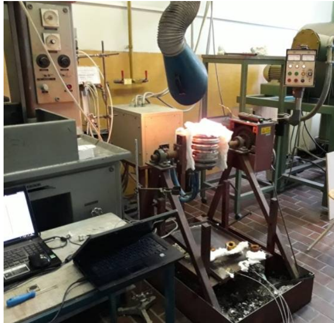
Slika 63. Taljenje materijala u indukcijskoj peći
