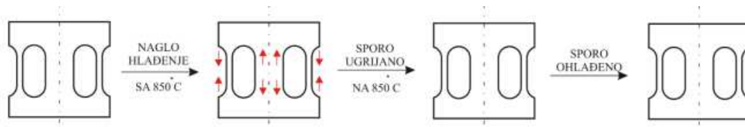
Slika 20. Shematski prikaz uklanjanja zaostalih naprezanja [35]
