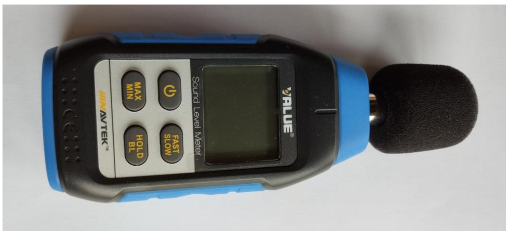
Slika 14. Zvukomjer, proizvođač Value, model VMS – 1
