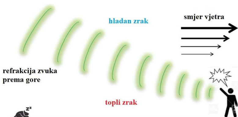
Slika 3. Refrakcija zvuka prema gore uslijed djelovanja hladnog zraka [6]
