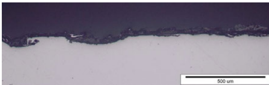
Slika 6. Oksidni sloj na površini uzorka iz morske atmosfere
