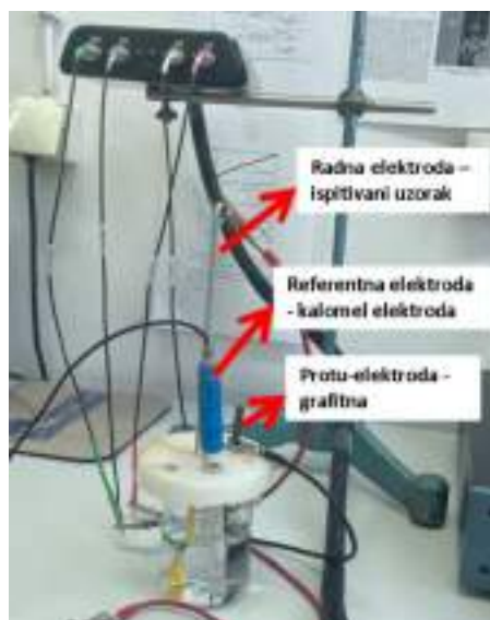
Slika 1. Troelektrodna ćelija za ispitivanje elektrokemijskom impedancijskom spektroskopijom
