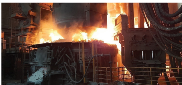
Ulaganje pripremljenoga starog željeza u elektrolučnu peć, ABS Sisak, 2021.
