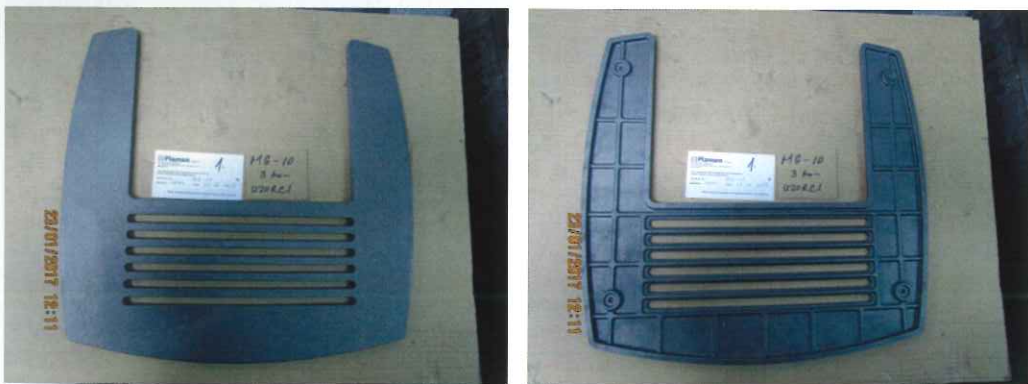
Slika 1. Kompleksna geometrija preiskovanega ulitka (zgornja in spodnja stran)
