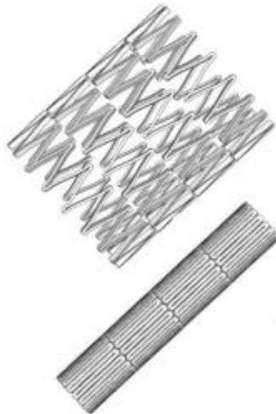
Slika 14. NiTi stent u ograničenom i obnovljenom obliku [17]
