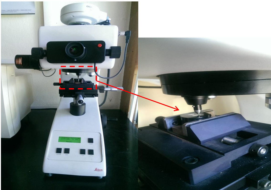
Slika 27. Fotografije tvrdomjera Leica korištenog za ispitivanje tvrdoće
