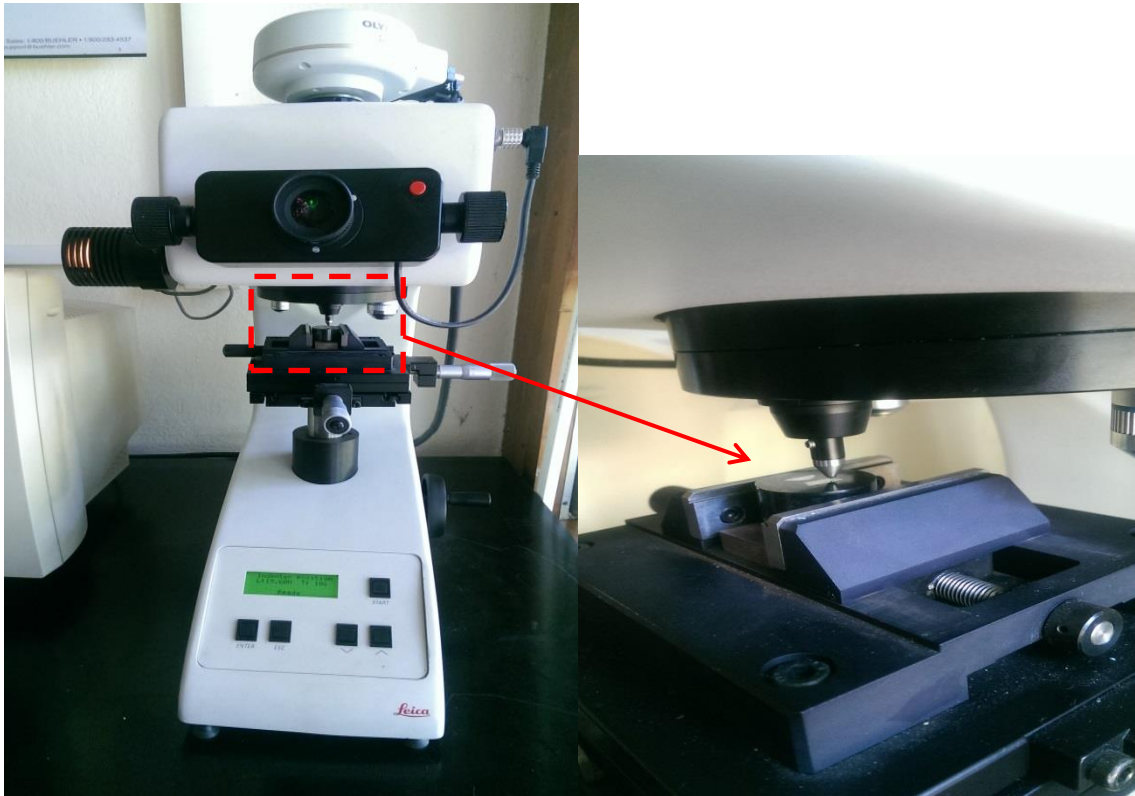
Slika 27. Fotografije tvrdomjera Leica korištenog za ispitivanje tvrdoće
