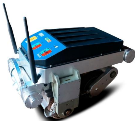
Рис. 6. Робот А2072 на базе магнитного транспортного устройства с колесной базой [7].
