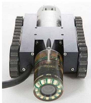
Рис. 2. Гусеничный робот-контроллер NanoMag [2].
