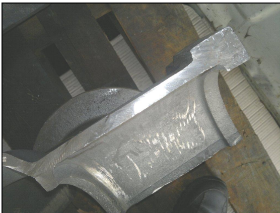
Slika 4.2. Kućište filtra KSF DN200 presječeno po visini radi ispitivanja poroznosti
