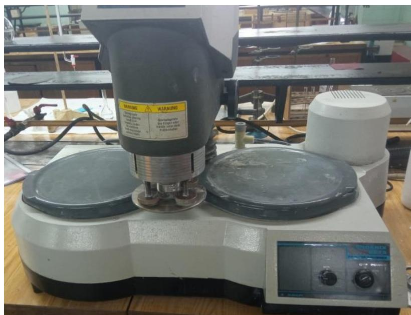
Slika 17. Uređaj za brušenje i poliranje
