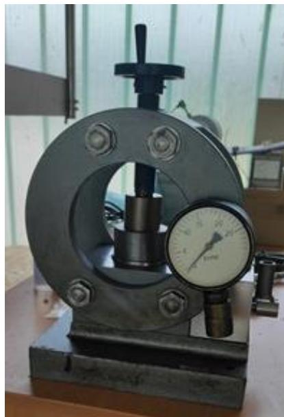
Slika 16. Hidraulična preša
