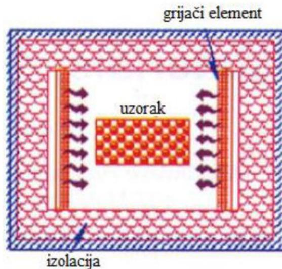
Slika 12. Shematski prikaz konvencionalne komorne peći za sinteriranje [13]
