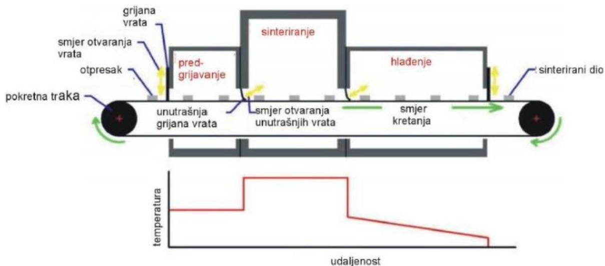
Slika 13. Shematski prikaz protočne peći za sinteriranje [13]
