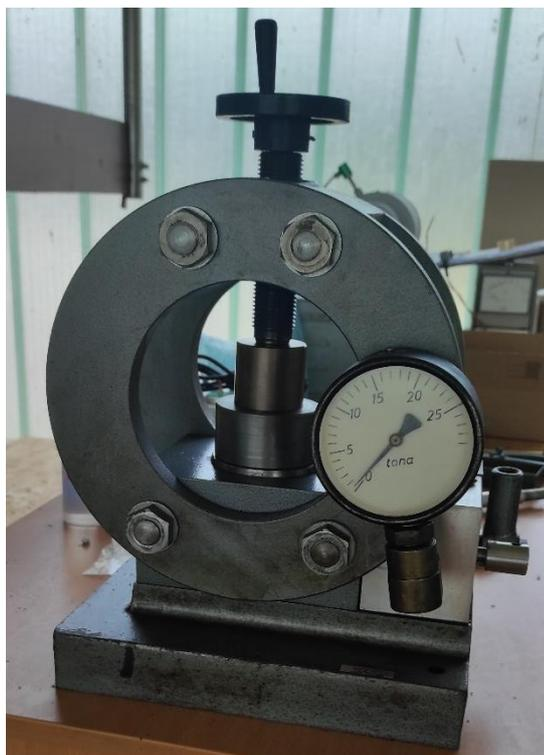
Slika 20. Hidraulička preša
