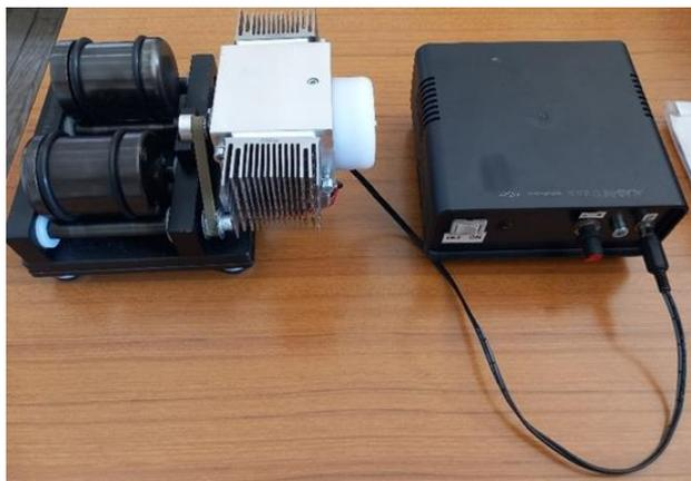
Slika 19. Kuglični mlin
