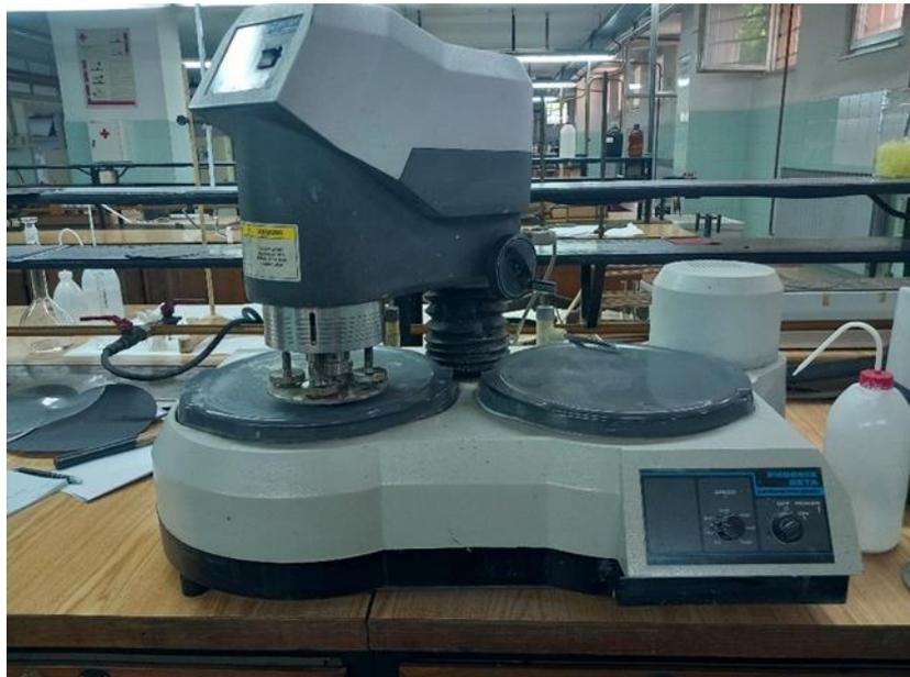
Slika 23. Uređaj za brušenje i poliranje
