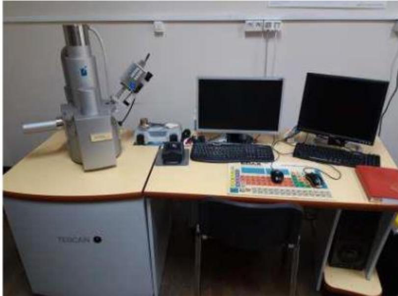
Slika 27. Tipični SEM instrument [32]
