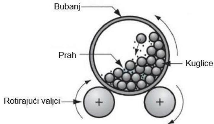
Slika 8. Shematski prikaz principa rada kugličnog mlina [11]
