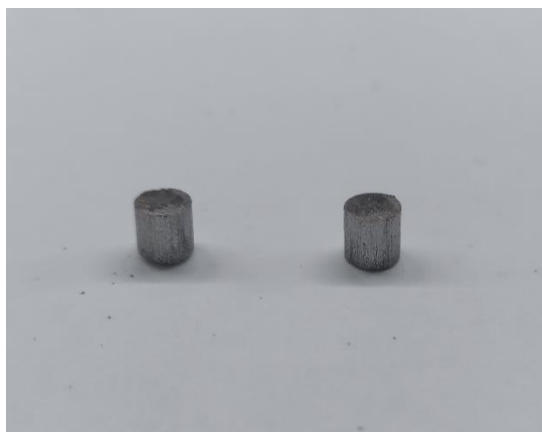
Slika 21. Otpresci Ti-8Cu legure
