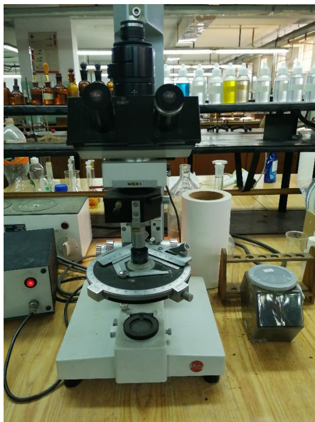
Slika 40. Metalografski svjetlosni mikroskop Leica Ortholux
