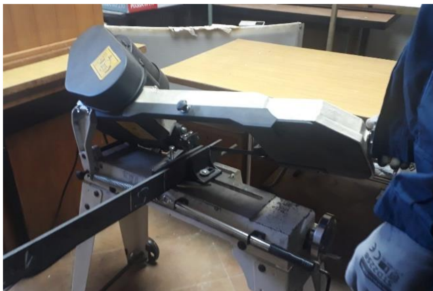
Slika 29. Rezanje uzoraka tračnom pilom
