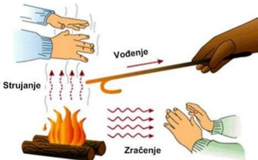
Slika 11. Načini izmjene topline s okolinom [19]
