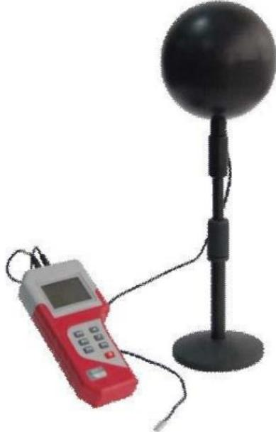
Slika 5. Globus termometar za mjerjenje temperature zračenja plohe [11]
