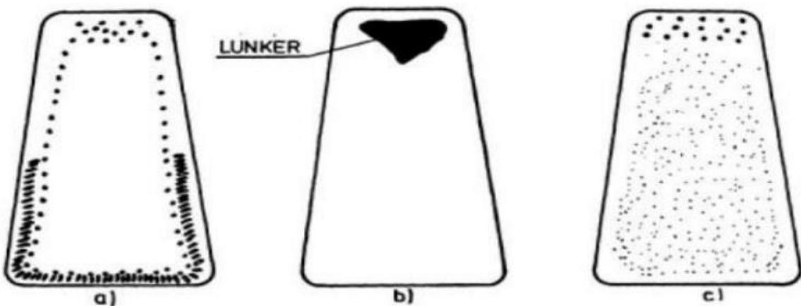
Slika 11. Poprečni presjek skrnutnutog ingota: a) neumiren, b) umiren i c) poluumiren [21]
