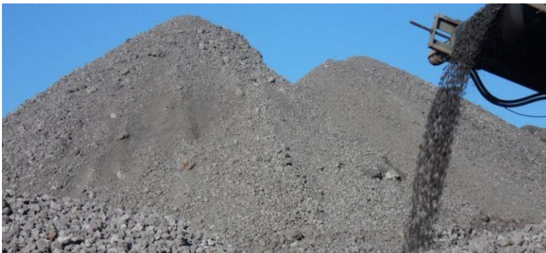
Slika 9. Odlaganje crne troske nastale proizvodnjom ugljičnih čelika u elektrolučnoj peći [17]
