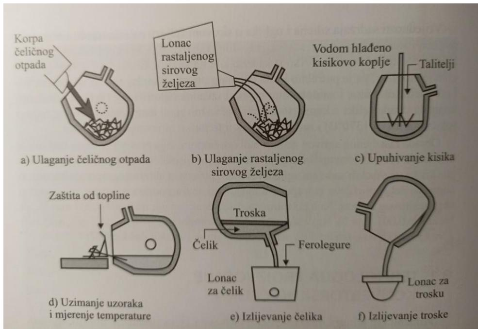
Slika 7. Faze proizvodnje čelika u kisikovom konvertoru [7]
