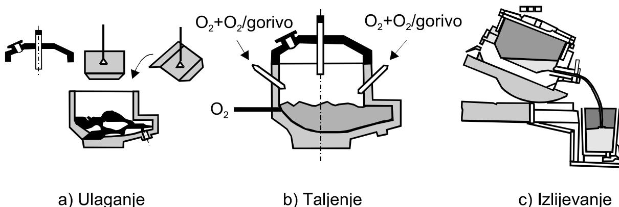
Slika 4. Shematski prikaz elektrolučnog postupka [7]
