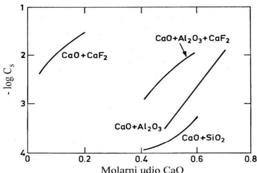
Slika 12. Ovisnost sulfidnog kapaciteta o molarnom udjelu CaO za neke troske pri 1600°C
