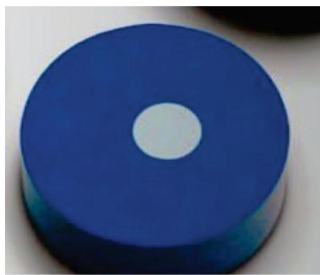
Slika 36. Metalografski pripremljen uzorak
