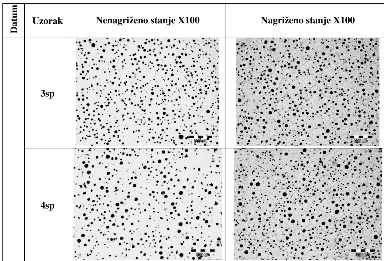
Slika 45. Mikrostruktura uzoraka u poliranom (nenangriženom) i nagriženom stanju.
