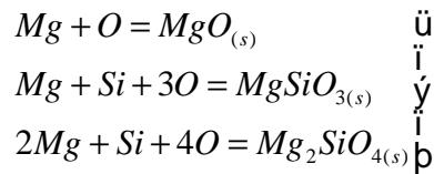
Produkti reakcije ovise o nodularizirajućem sredstvu i postupku obrade. Čisti magnezijev oksid ( $MgO$ ) je prevladavajući produkt pri dodatku Mg-metala, dok su pri dodatku FeSiMg legure koja sadrži oko 45% silicija, prevladavajući produkti silikati enstatit i forsterit.
