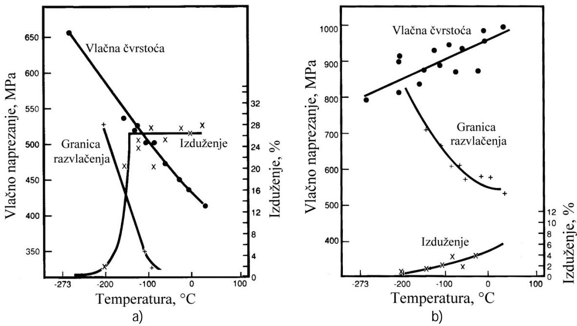
Slika 32. Utjecaj temperature na vlačna svojstva a) feritnog nodularnog lijeva, b) perlitnog nodularnog lijeva [2].
