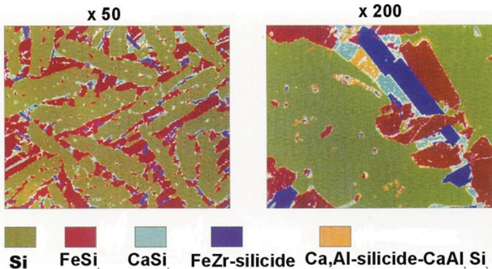
Slika 27. Mikrostruktura FeSiMg s identificiranim fazama [32]
