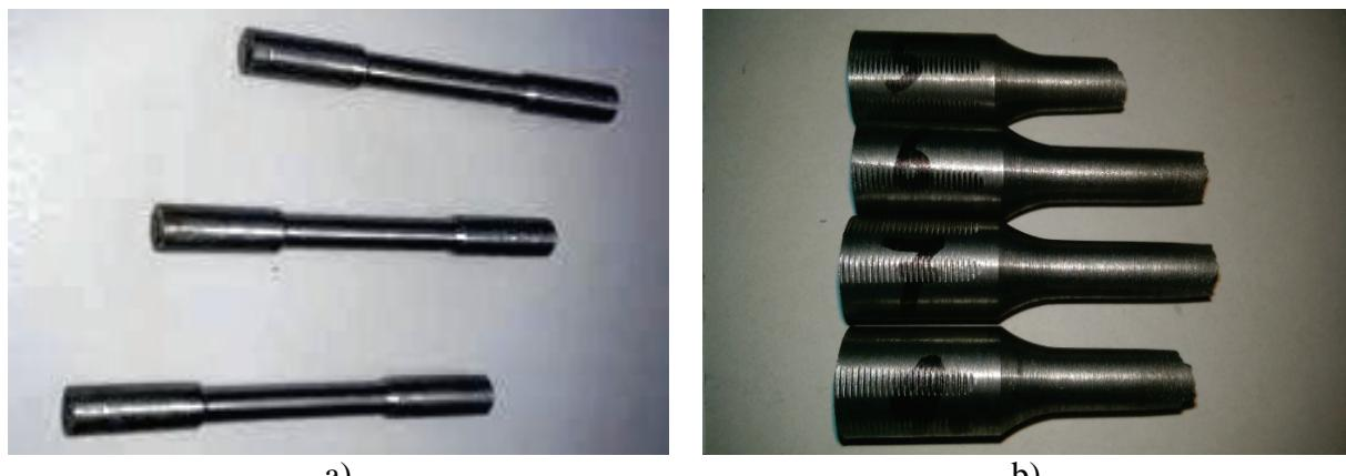
Slika 38. Epruvete za ispitivanje vlačne čvrstoće a) prije ispitivanja i b) nakon ispitivanja.
