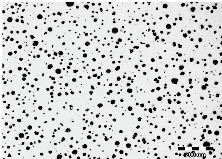
Slika 4. Mikrostruktura feritno-perlitnog nodularnog ljeva, nenagriženo stanje, povećanje 100X.
