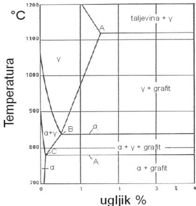
Slika 22. Presjek ternarnog dijagrama stanja sistema Fe-C-2% Si [9].
