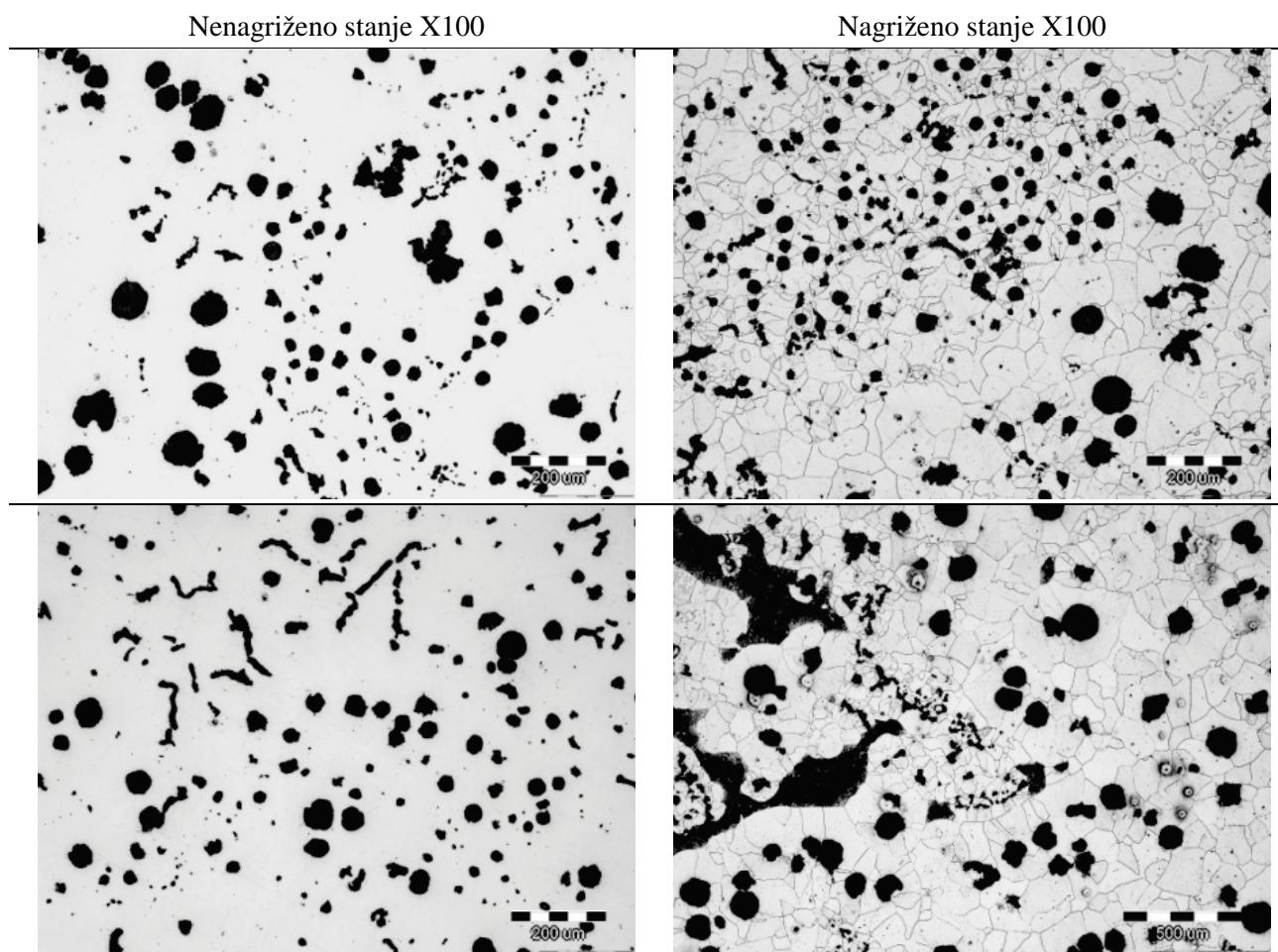
Slika 42. Mikrostruktura odljevka na području u blizini greške.
