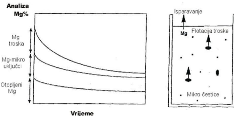
Slika 26. Rezidualni Mg i slabljenje djelovanja Mg [31].
