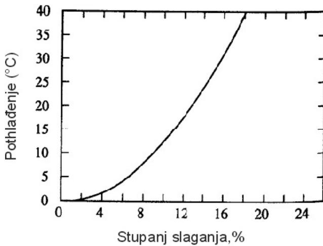
Slika 20. Pothlađenje u zavisnosti od plošnog odstupanja rešetke [29].
