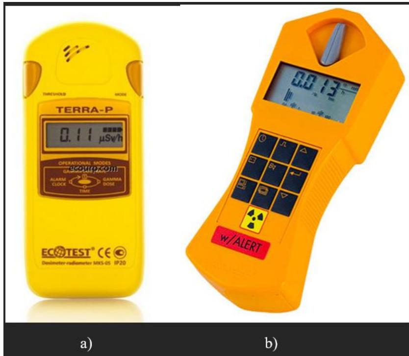
Slika 5. Uređaji za mjerjenje zračenja: a) dozimetar i b) Geigerov brojač [20, 21]
