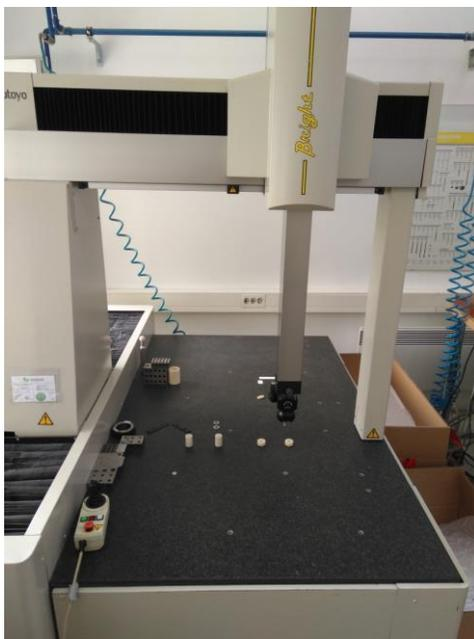
Slika 4. Automatski mjerni uređaj Bright 710
