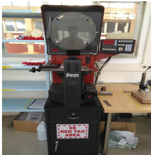
Slika 6. Optički komparator Starret Sigma HB400
