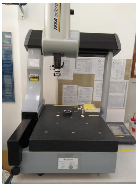
Slika 5. Ručni mjerni uređaj Tesa Micro-Hite 3D
