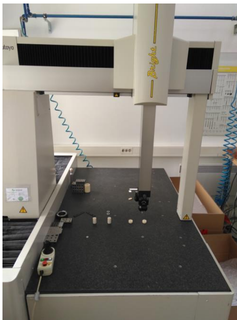
Slika 4. Automatski mjerni uređaj Bright 710
