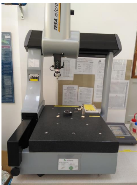
Slika 5. Ručni mjerni uređaj Tesa Micro-Hite 3D
