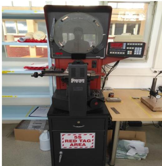
Slika 6. Optički komparator Starret Sigma HB400
