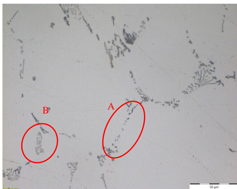
Slika 31. Nelegirani (dezox) Al pri povećanju 500x
