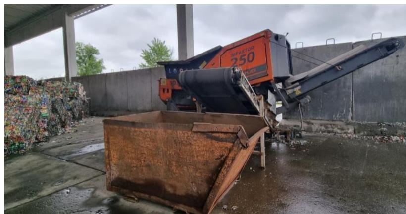
Slika 14. Šredder s magnetskim separatorom
