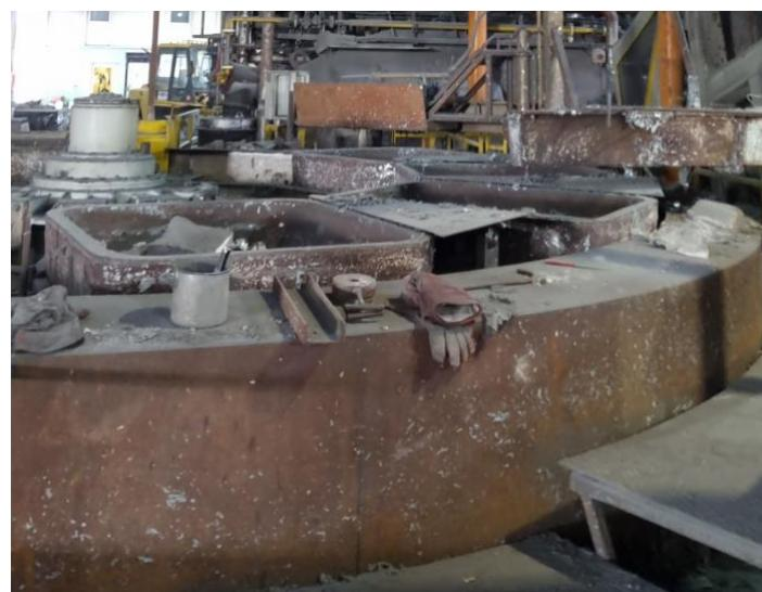
Slika 16. Rotacijski kalupi (karusel)
