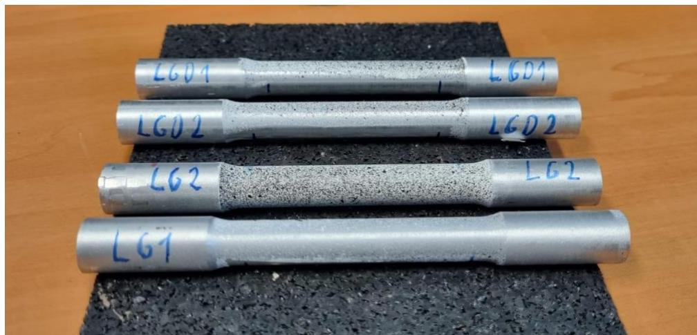
Slika 21. Uzorci okruglog poprečnog presjeka
