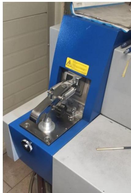
Slika 20. Spektrometar SPECTROMAXx
