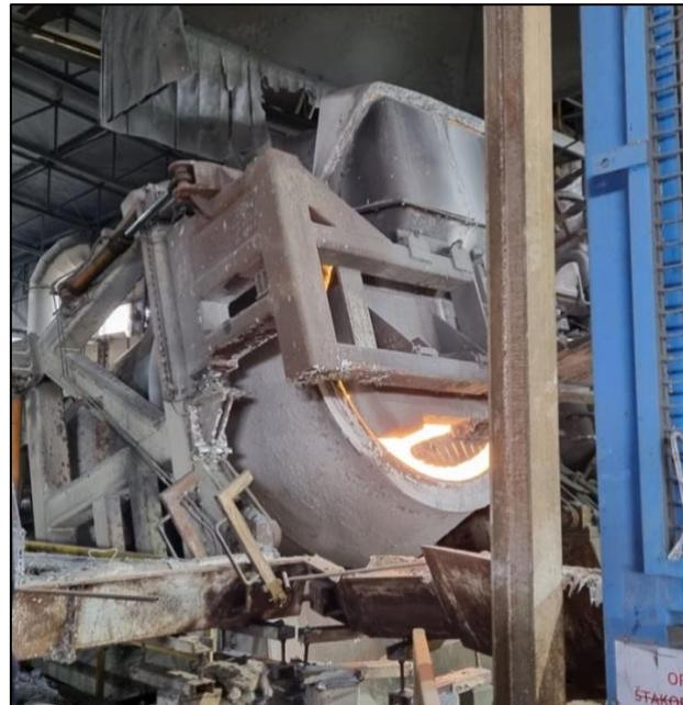
Slika 15. Rotacijska nagibna peć
