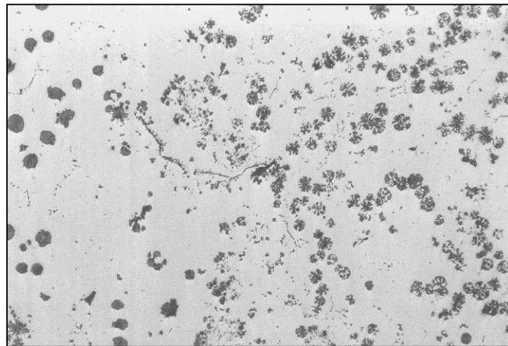
Slika 10. Eksplodirani grafit u mikrostrukturi nodularnog lijeva [17]
