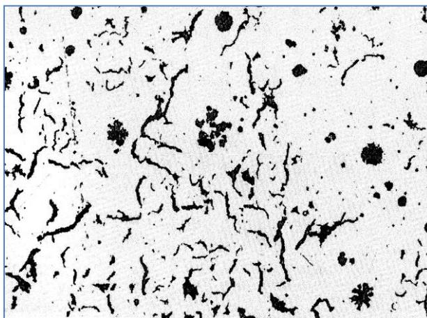
Slika 17. Vermikularni grafit u mikrostrukturi nodularnog lijeva [17]
