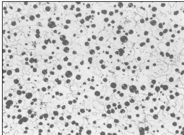
Slika 1. Metalografska snimka mikrostrukture feritnog nodularnog lijeva u nagrizenom stanju, nital [4]
