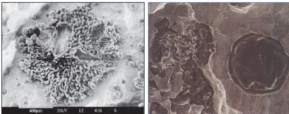
Slika 13. Eutektične celije „*chunky*“ grafta snimljene pretražnim elektronskim mikroskopom [16, 33]
