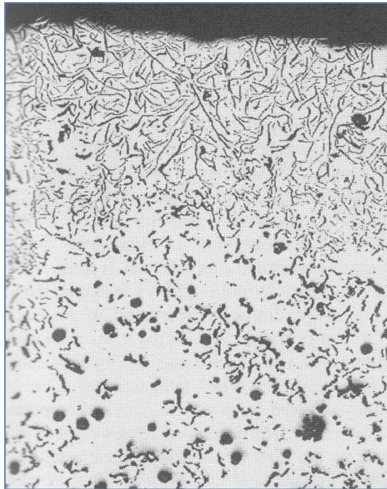
Slika 18. Lističavi grafit u površinskom sloju odljevka od nodularnog lijeva [17]
