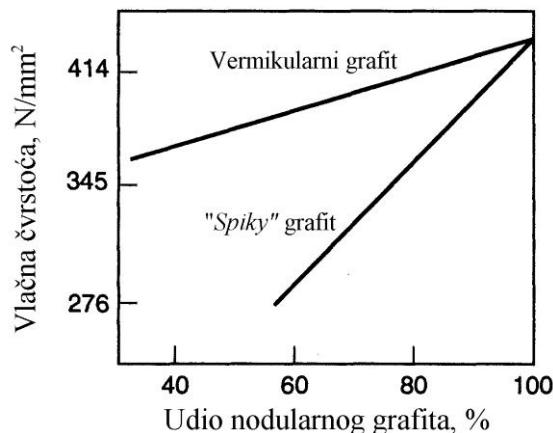
Slika 16. Utjecaj „spiky“ i vermkularnog grafita na vlačnu čvrstoću nodularnog lijeva [17]
