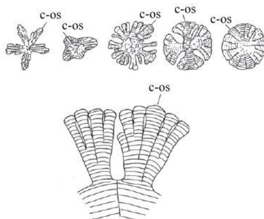
Slika 11. Mehanizam rasta eksplodiranog graftita [16]
