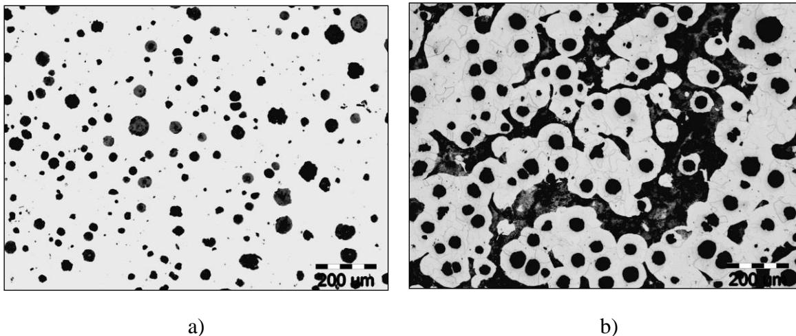
Slika 20. Metalografske snimke mikrostrukture feritno-perlitnog nodularnog lijeva:
