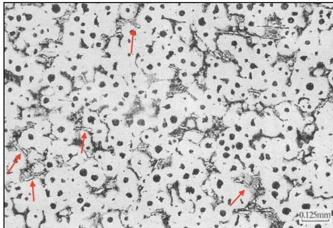
Slika 24. Metalografska snimka mikrostrukture nodularnog lijeva koji sadrži međučelijaste karbide [13]
