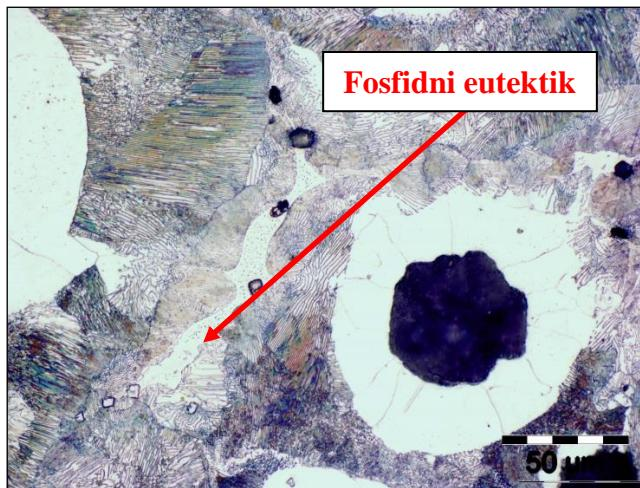
Slika 23. Metalografska snimka mikrostrukture nodularnog lijeva u nagrizenom stanju (nital) pri povećanju 500x. Zbog visokog udjela fosfora ( $P = 0,085\%$ ) u mikrostrukturi je prisutan fosfidni eutektik [18]
