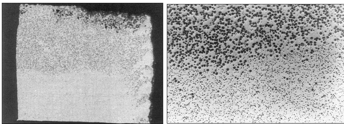
Slika 7. Flotacija grafita u odljevku od nodularnog lijeva debljine 80 mm, ugljični ekvivalent CE = 4,47. Udio ugljika u području flotacije iznosi 5,5 %, a ispod tog područja 3,3 %:
