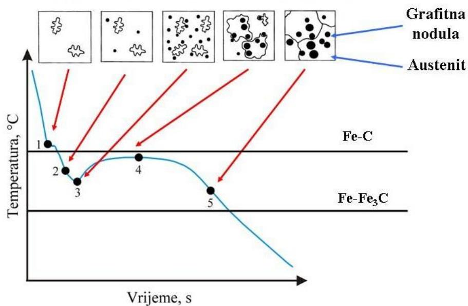
Slika 3. Shematski prikaz krivulje hlađenja podeutektičnog nodularnog lijeva [1]
