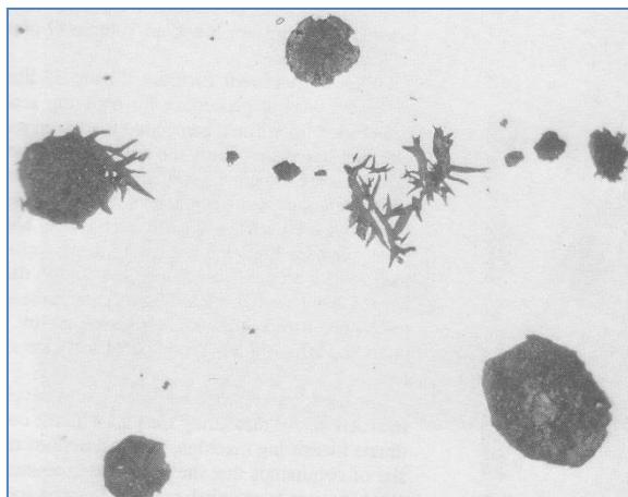
Slika 15. „*Spiky*“ grafit u mikrostrukturi nodularnog lijeva [17]
