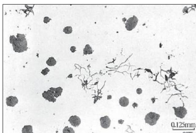
Slika 19. Međućelijasti lističavi grafit u mikrostrukturi nodularnog lijeva [13]
