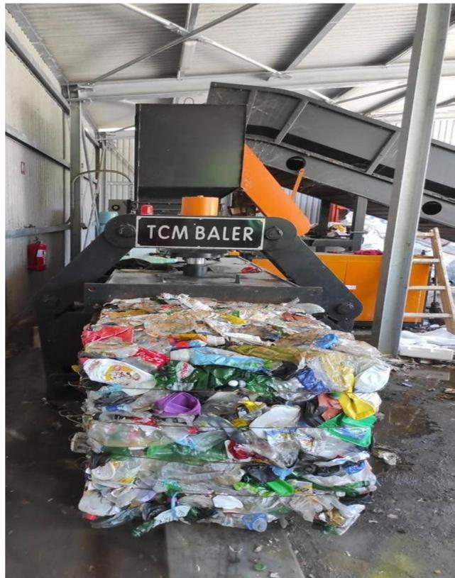
Slika 11. Bala na izlaznoj traci uređaja za baliranje
