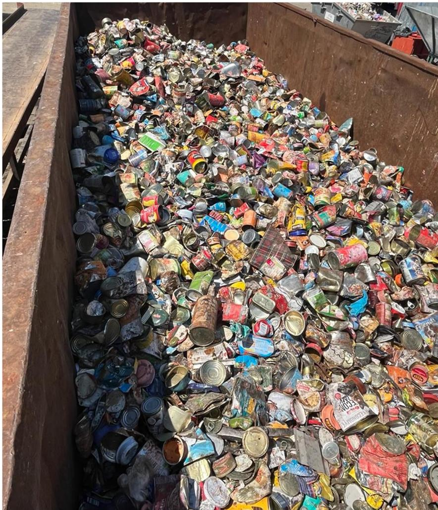
Slika 7. Skladištenje metalne ambalaže u kontejneru zapremnine  $40 \text{ m}^3$
