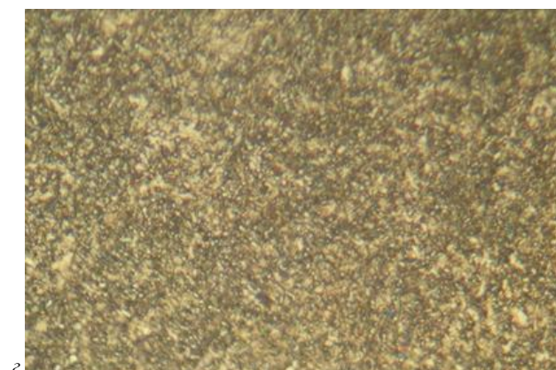
Рис. 2. Микроструктура стали 5ХВ2С после термической обработки; \times 1000 а - ковка, закалка 880 °С + отпуск 200 °С; б - ковка, закалка 880 °С + отпуск 500 °С; в - отжиг, закалка 880 °С + отпуск 200 °С; г - отжиг, закалка 880 °С + отпуск 500 °С
