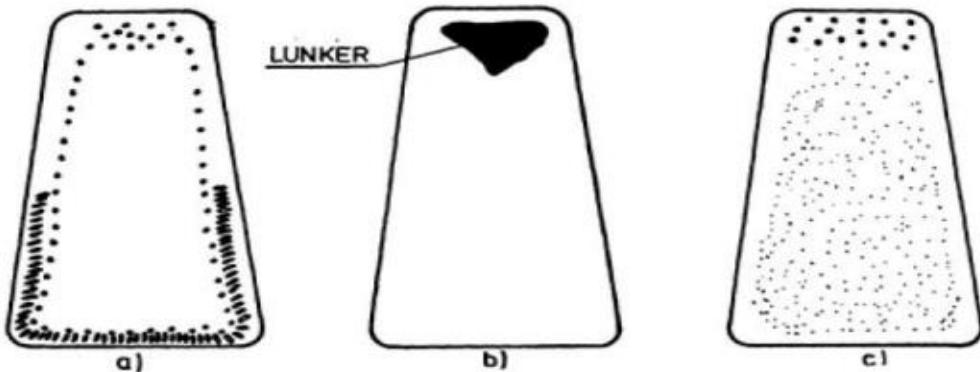
Slika 7. Poprečni presjek skrtnutog ingota [16]
