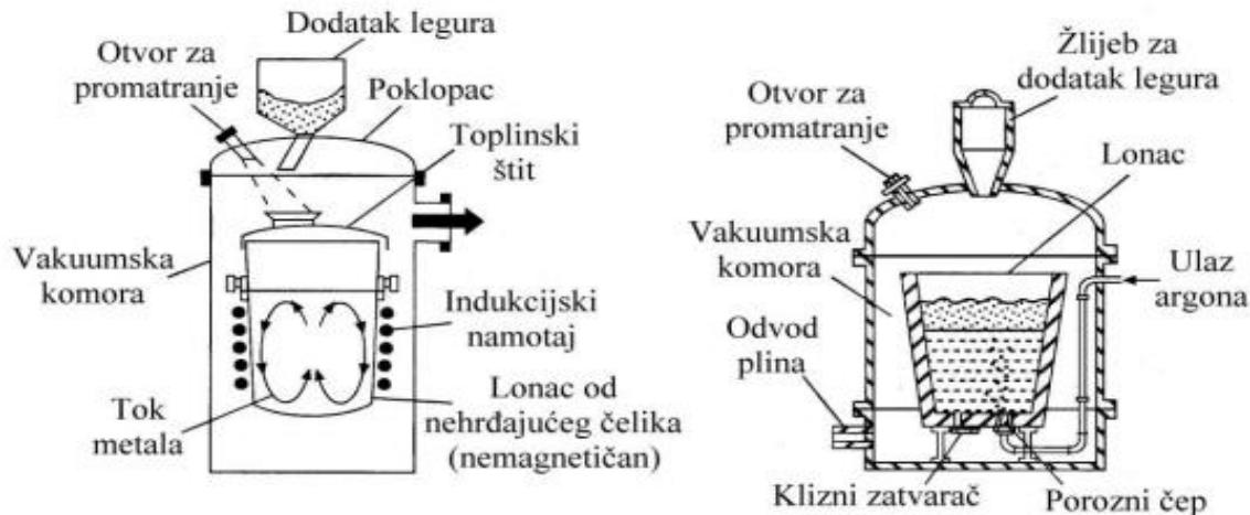
Slika 6. VD postupak: a) elektromagnetsko miješanje taline u loncu,
