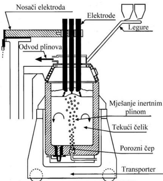
Slika 5. Shematski prikaz lonac – peći [15]
