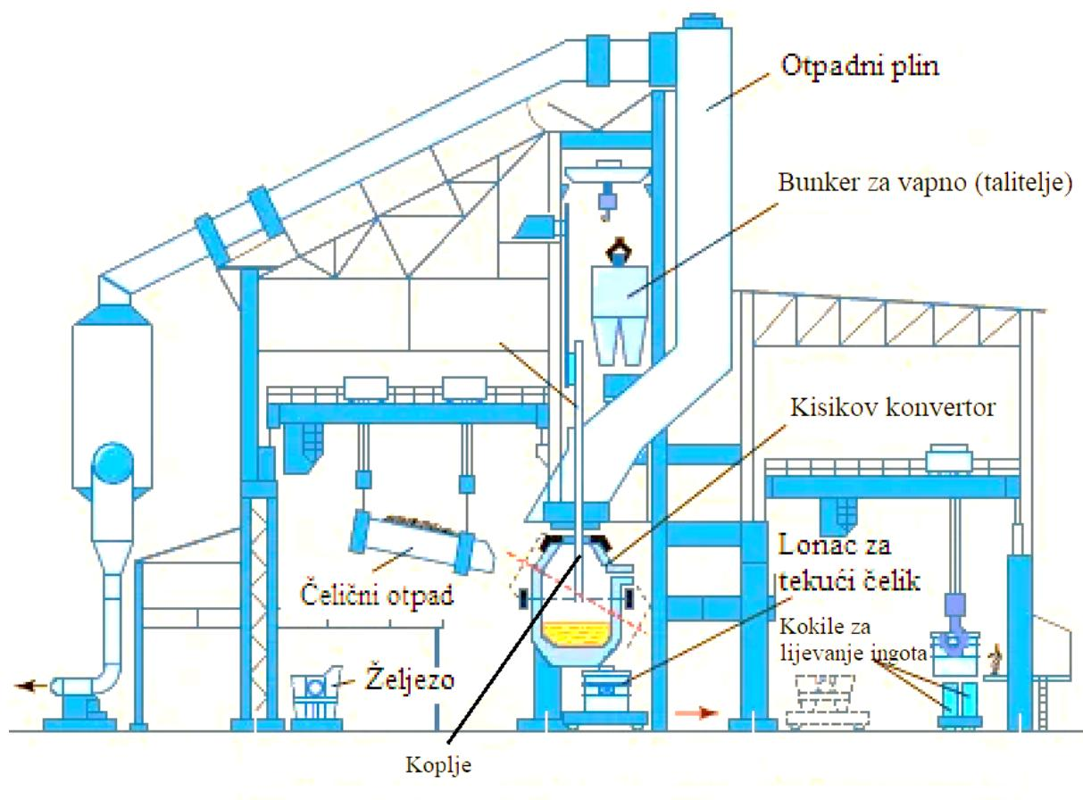
Slika 3. Shematski prikaz kisikovog konvertora s pratećom opremom [10]
