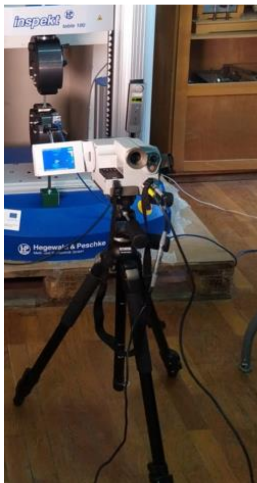
Slika 30. Položaj termalne kamere tijekom ispitivanja
