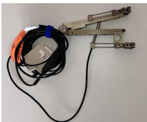
Slika 34. Kontaktni ekstenzometar
