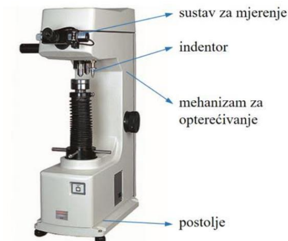
Slika 10. Tvrdomjer i njegove komponente [20]
