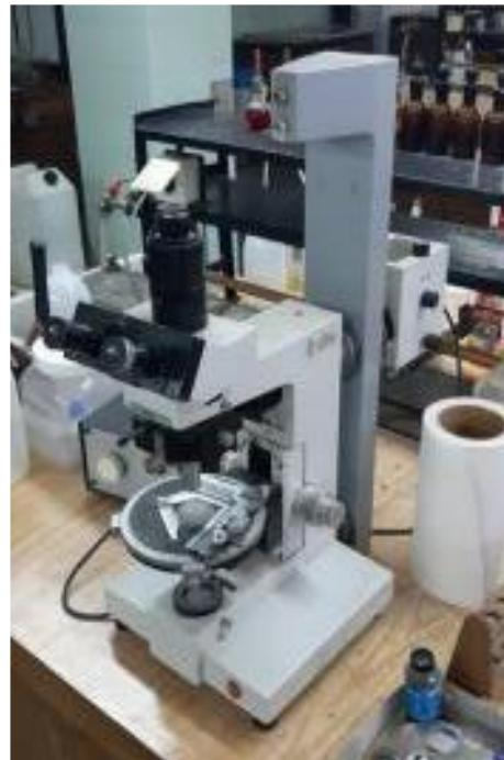
Slika 24. Metalografski svjetlosni mikroskop Leica Ortholux
