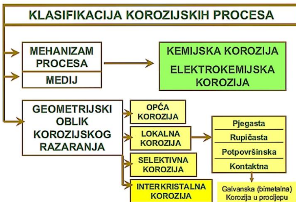
Slika 5. Podjela korozijskih procesa [12]
