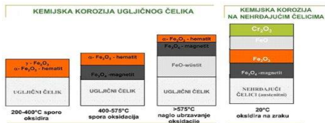
Slika 6. Nastanak pasivnog sloja na ugljičnom i nehrđajućem čeliku [15]
