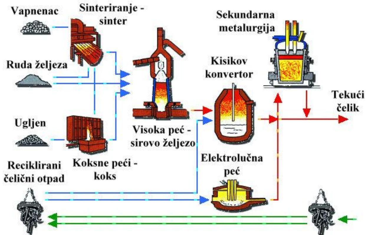
Slika 2. Postupak proizvodnje sirovog željeza i čelika [5]
