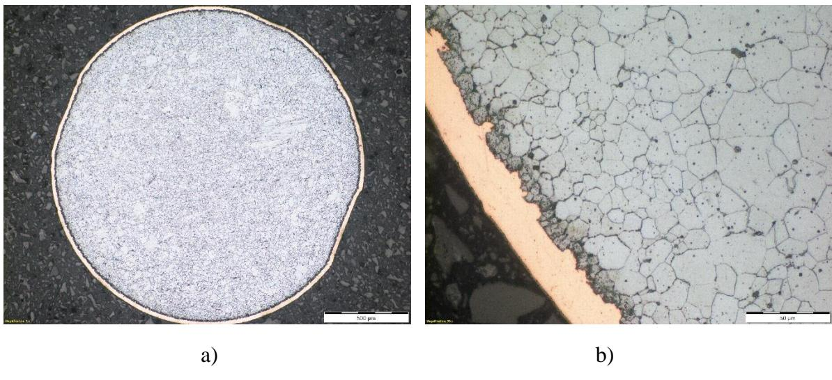
Slika 16. Mikrostruktura naušnica u nakon nagrizanja u nitalu:
