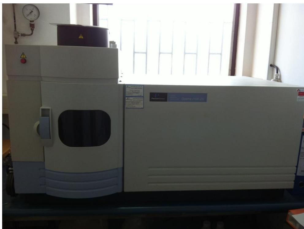
Slika 14. Spektrometar s induktivno spregnutom plazmom (ICP-OES)
