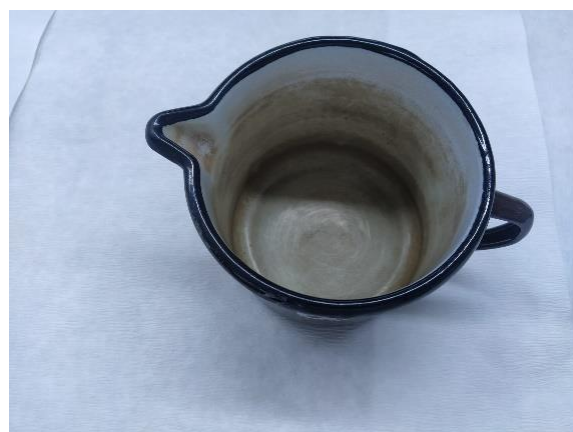
Slika 13. Posuđe izrađeno od nelegiranog hladno valjanog niskougličnog čelika (emajlirano): a) novo posuđe, b) korišteno posuđe
