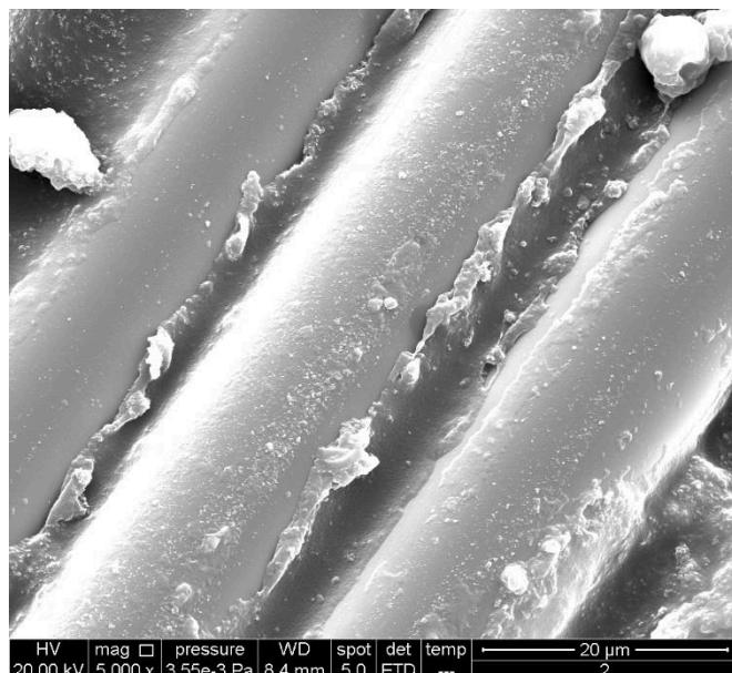
Slika 26. a) SEM prikaz staklene mrežice s posipanim TiO<sub>2</sub>.
