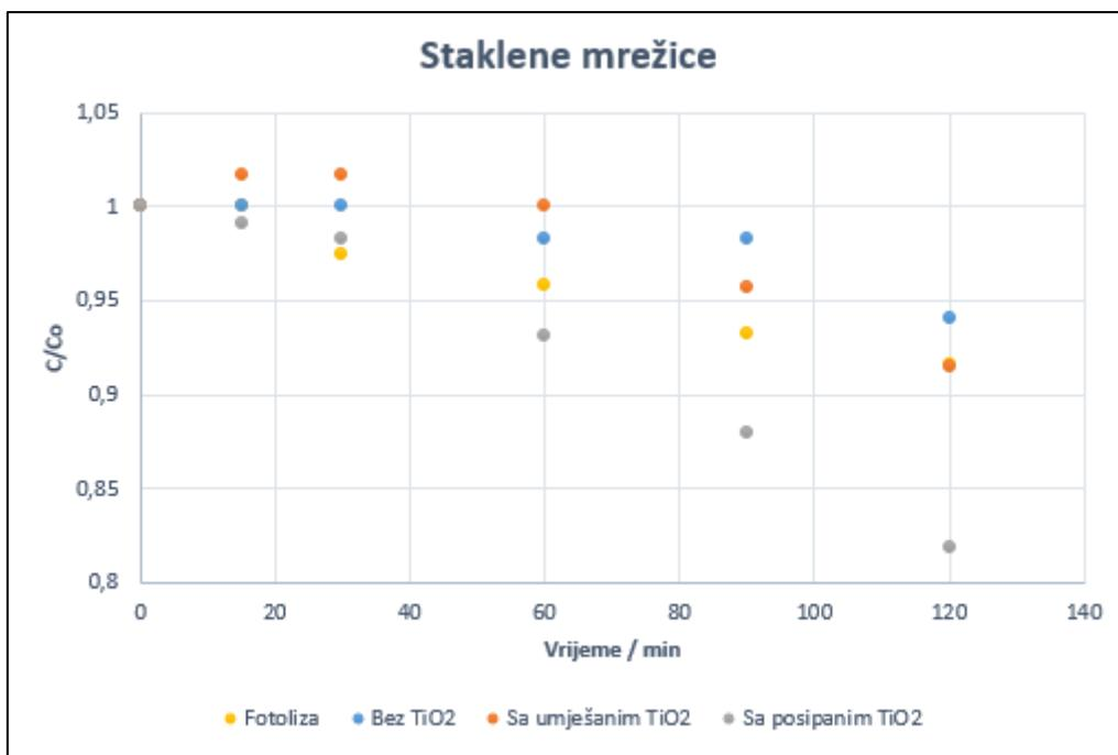
Slika 20. Ispitivanje fotokatalitičke aktivnosti TiO<sub>2</sub> na staklenim mrežicama.
