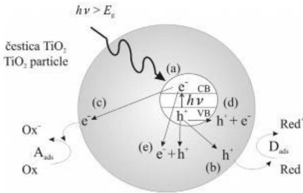
Slika 7. Fotokatalitički proces na  $\text{TiO}_2$  katalizatoru [38]:
