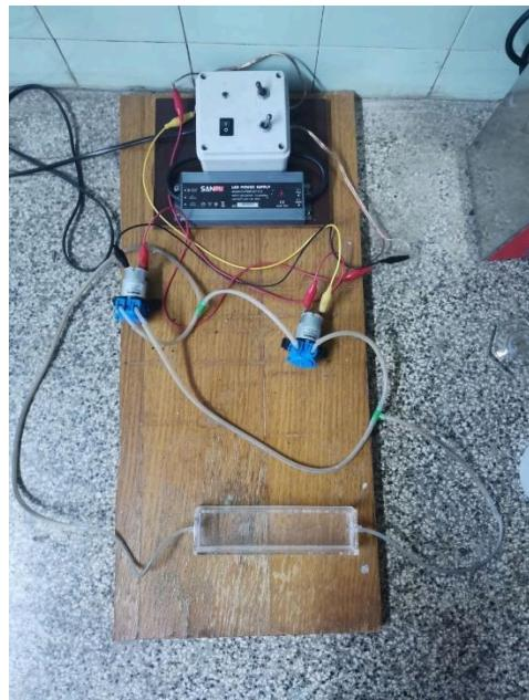
Slika 18. Reaktor za ispitivanje fotokatalitičkih svojstava.
