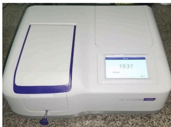
Slika 15. Spektrometar Onda UV-31 SCAN.
