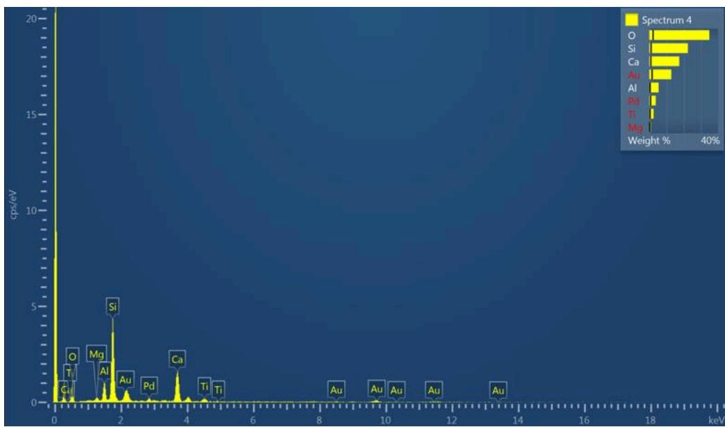
Slika 26. b) EDS prikaz staklene mrežice s posipanim  $\text{TiO}_2$ .
