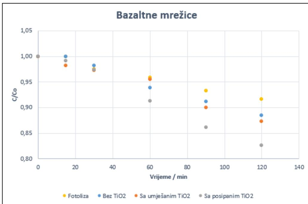
Slika 21. Ispitivanje fotokatalitičke aktivnosti TiO<sub>2</sub> na bazalnim mrežicama.
