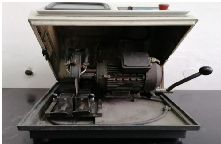
Slika 33. Fotografija uređaja za rezanje uzoraka Buehler ABRASIMET 2
