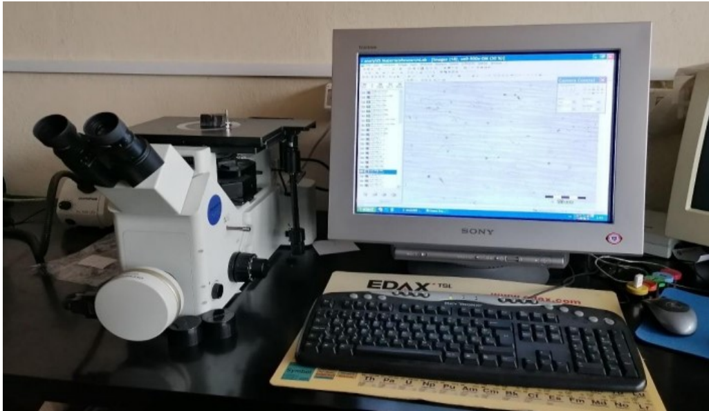
Slika 36. Fotografija svjetlosnog mikroskopa Olympus GX51 s kamerom DP70
