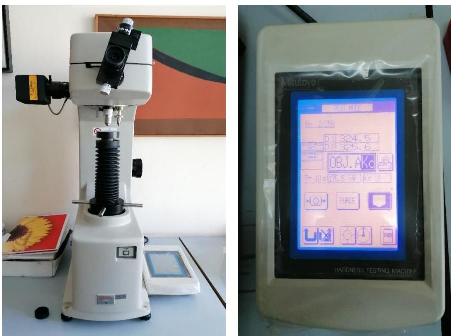
Slika 30. Prikaz uređaja za mjerjenje tvrdoće
