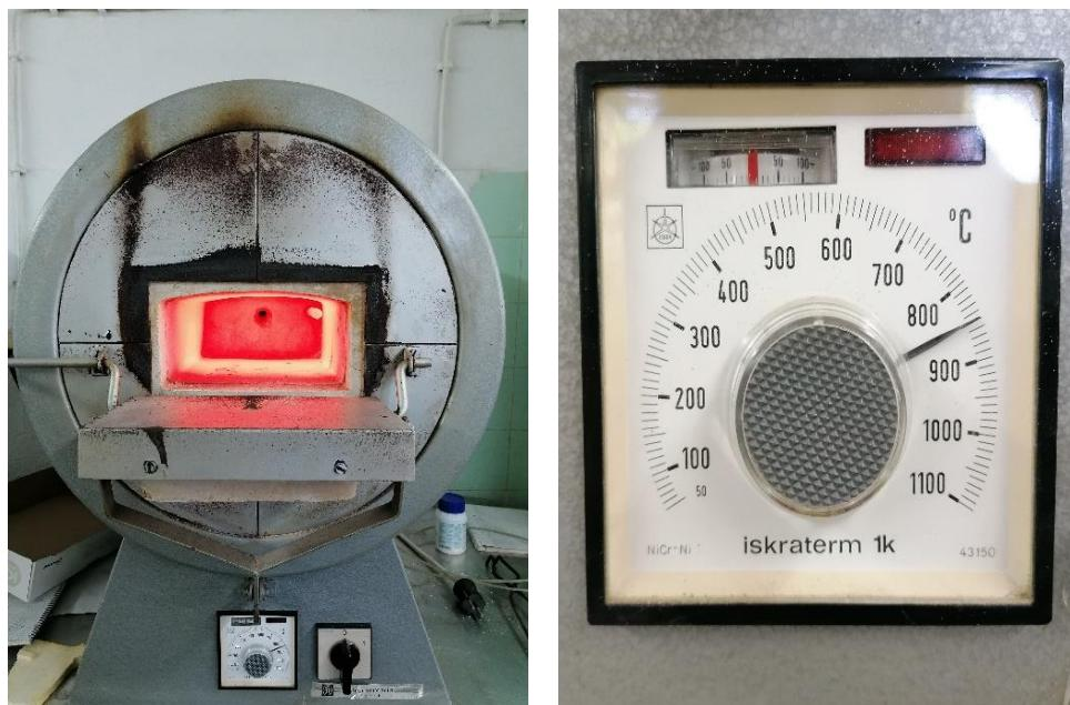
Slika 20. Prikaz elektrootporne peći i temperature žarenja uzorka CuAlMn legure
