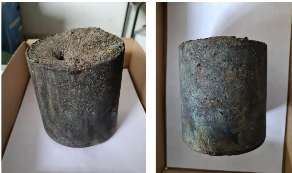
**Slika 18.** Lijevani ingot CuAlMn legure s prisjetljivosti oblika
