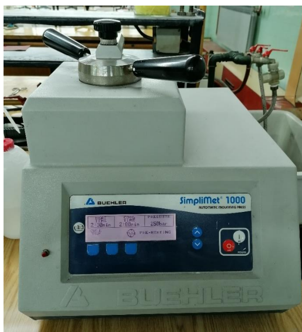
Slika 24. Prikaz uređaja Buehler SimpliMet 1000 za vruće prešanje uzoraka
