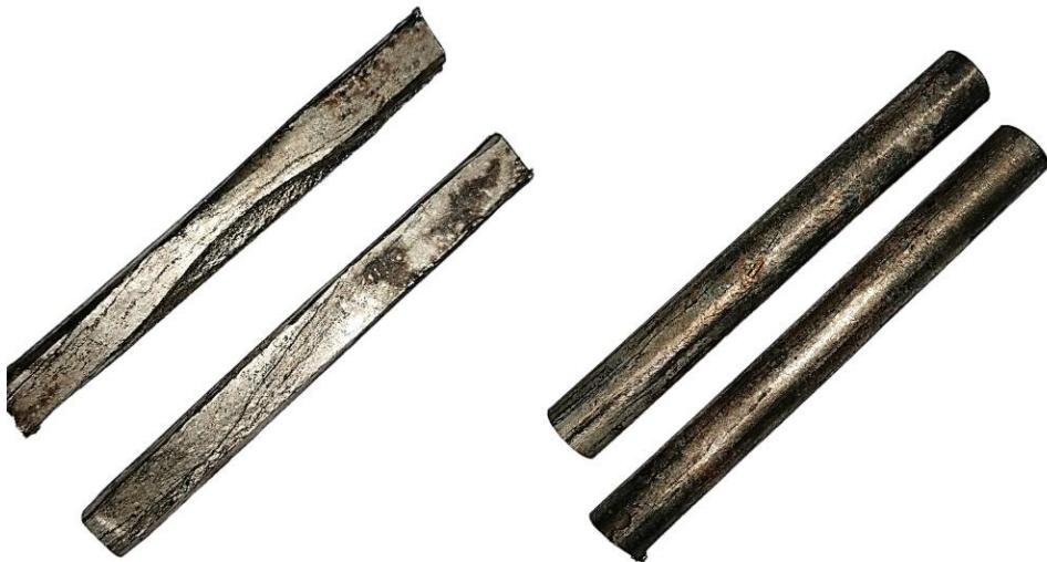
**Slika 22.** Uzorci CuAlMn legure nakon toplinske obrade
