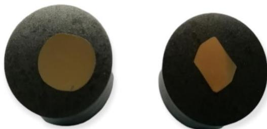
**Slika 26.** Prikaz uzorka TO6,5 i TO13 nakon brušenja, poliranja i nagrizanja
