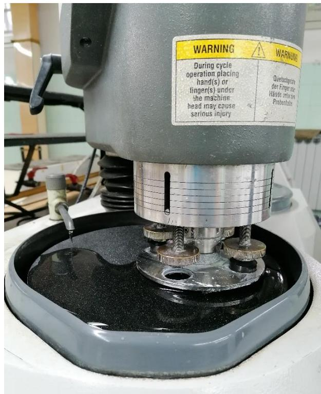
**Slika 25.** Prikaz uređaja za brušenje i poliranje uzorka
