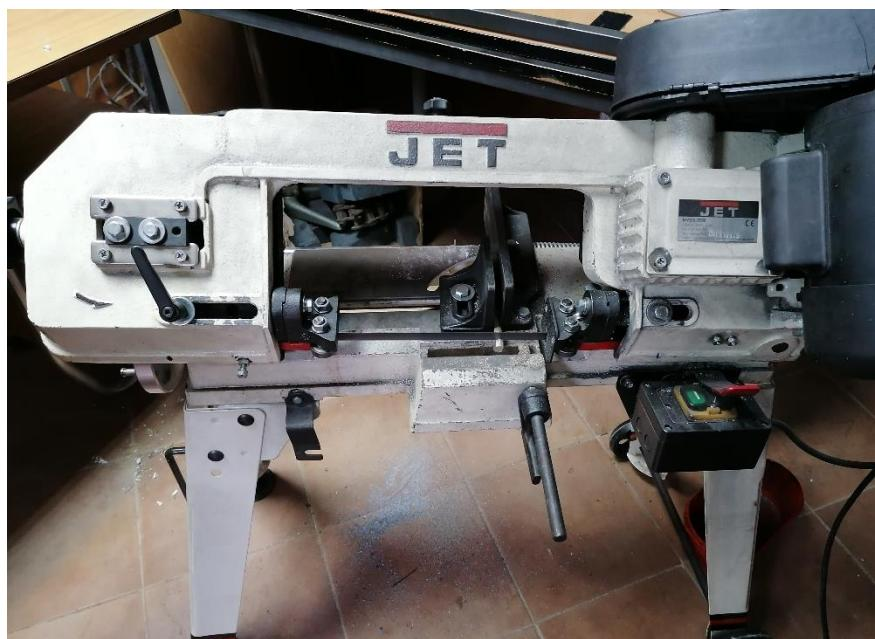
**Slika 23.** Prikaz JET rezalice uzoraka CuAlMn legure
