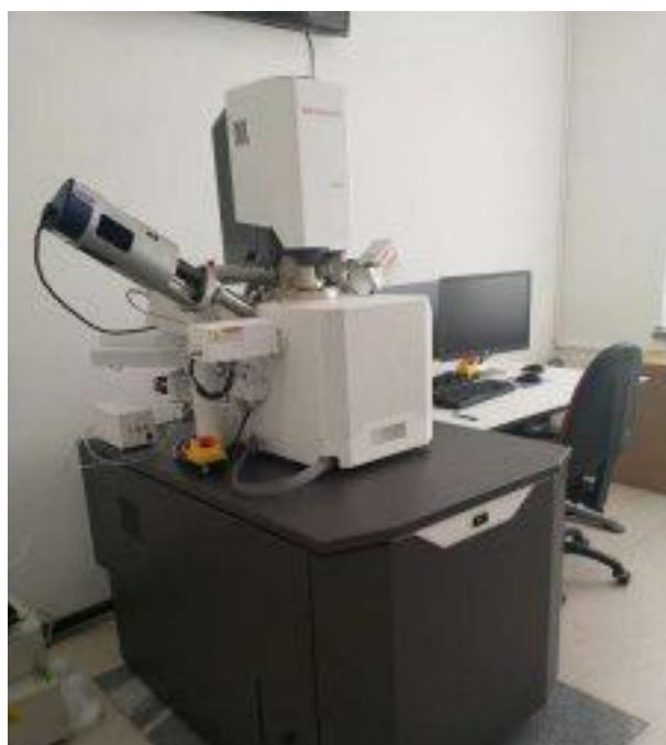
**Slika 28.** Pretražni elektronski mikroskop FEG-SEM Thermofisher Quattro S
