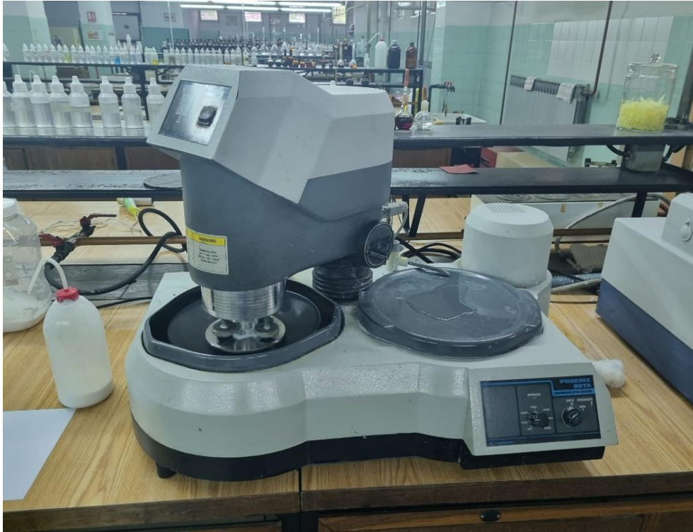
Slika 8. Uređaj za brušenje i poliranje Buheler Phoenix Beta
