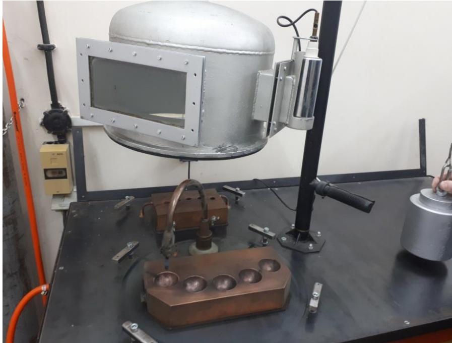
Slika 5. Fotografija elektrolučne peći
