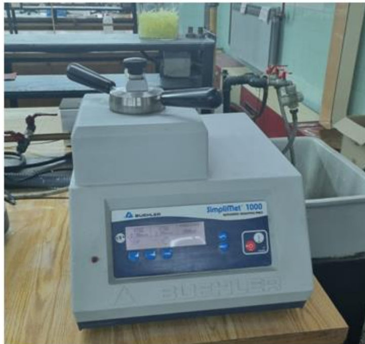
Slika 7. Uređaj za vruće prešanje Buehler Simplimet 1000
