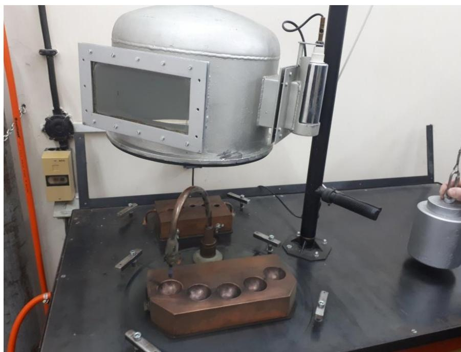
Slika 5. Fotografija elektrolučne peći
