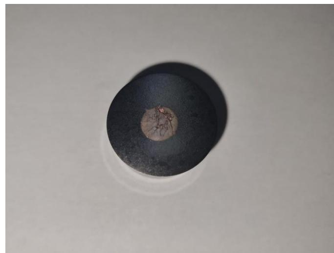
Slika 9. Uzorak 50Cu-50Zr legure nakon nagrizanja
