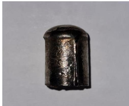
Slika 6. Fotografija dobivenog uzorka 50Cu-50Zr legure nakon lijevanja u bakrenu kokilu
