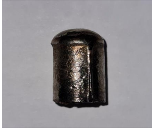
Slika 6. Fotografija dobivenog uzorka 50Cu-50Zr legure nakon lijevanja u bakrenu kokilu
