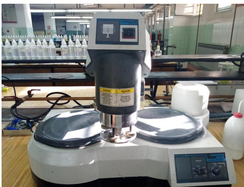
Slika 21. Automatski uređaj za brušenje i poliranje (Büehler)
