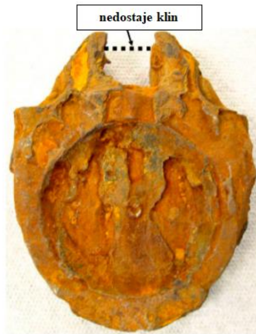
Slika 3. Opća korozija zasuna [8]
