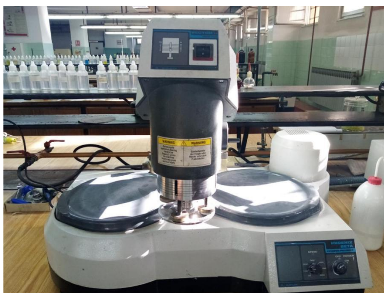
Slika 21. Automatski uređaj za brušenje i poliranje (Büehler)
