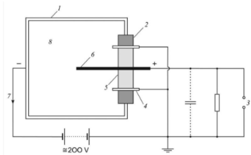
IONIZACIJSKA KOMORA, cilindrična komora (katoda), 2. vanjski izolator, 3. izlaz u pojačalo, 4. zaštitni prsten, 5. unutrašnji izolator, 6. anoda, 7. struja, 8. plin
