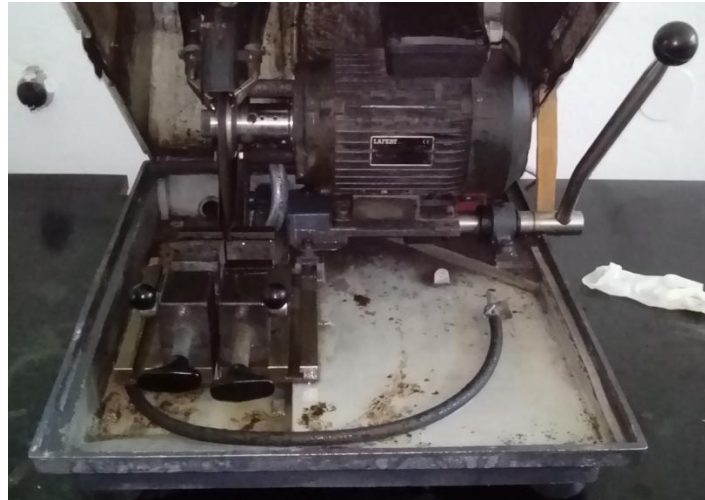
Slika 53. Rezalica za odrezivanje uzoraka iz epruvete
