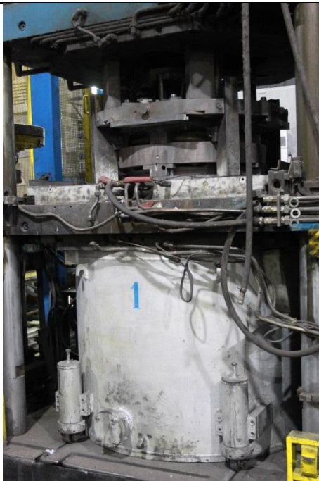
Slika 47. Lijevanje uzoraka AlSi7Mg legure
