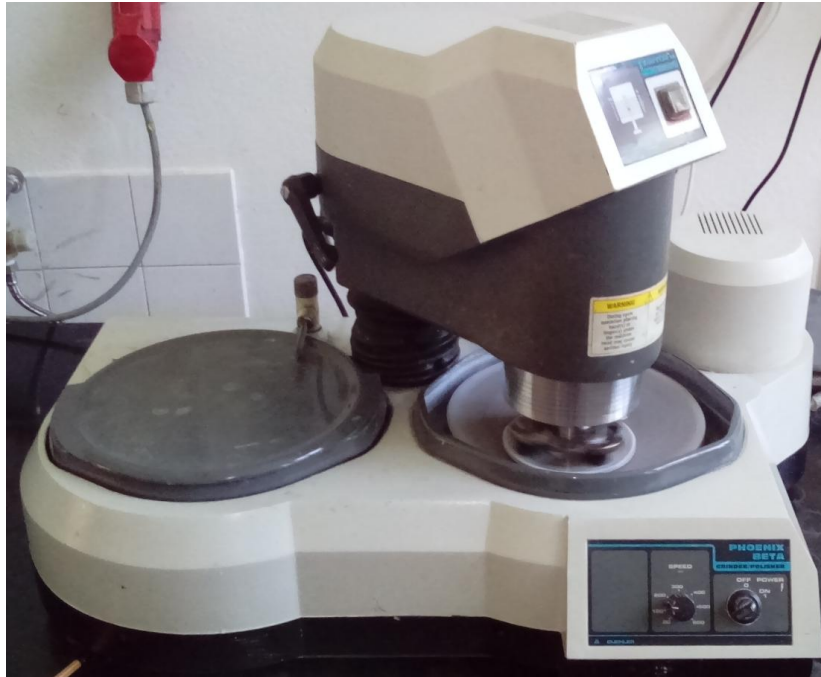
Slika 55. Uređaj za brušenje i poliranje Vektor LC proizvođača Buehler
