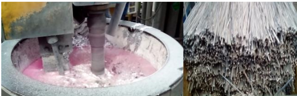
Slika 44. Metalurška obrada taline u transportnom loncu
