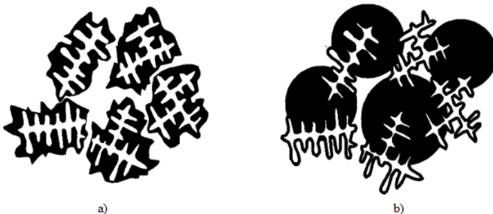
Slika 31. Shematski prikaz nastajanja eutektika prema postojećim mehanizmima [15]
