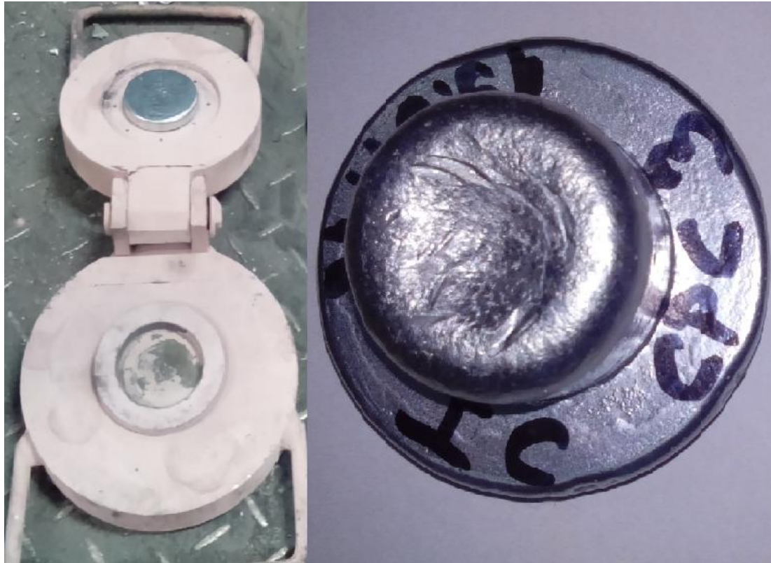
a) b) Slika 46. Prikaz izrade uzoraka za analizu kemijskog sastava a) čelična kokila za izradu pločica za ispitivanje kemijskog sastava b) uzorak u obliku pločice za ispitivanje kemijskog sastava
