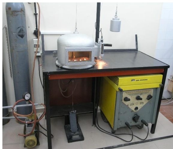
Slika 5. Laboratorijska elektrolučna peć na Metalurškom fakultetu [11]
