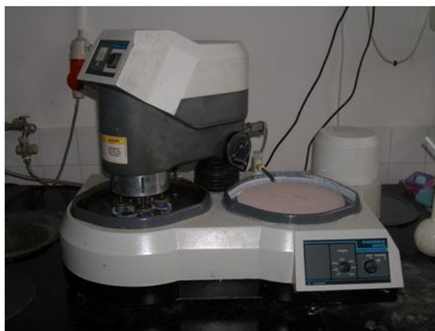
Slika 34. Uređaj za automatsku pripremu uzoraka Vector LC (Buehler)
