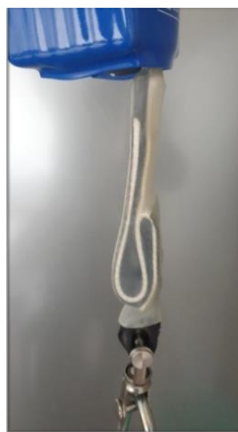
Slika 23. Dio koji označuje neupotrebljivost pojasa
