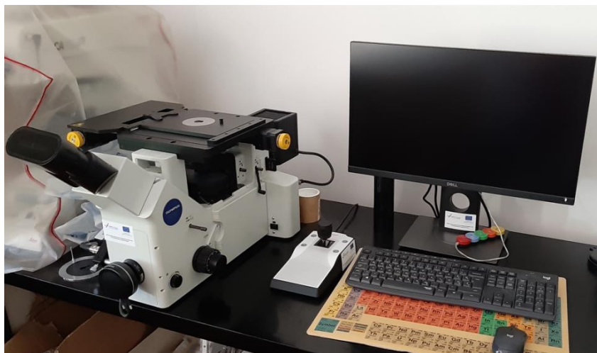
Slika 24. Invertni metalografski mikroskop Olyimpus GX51 s digitalnom kamerom DP70
