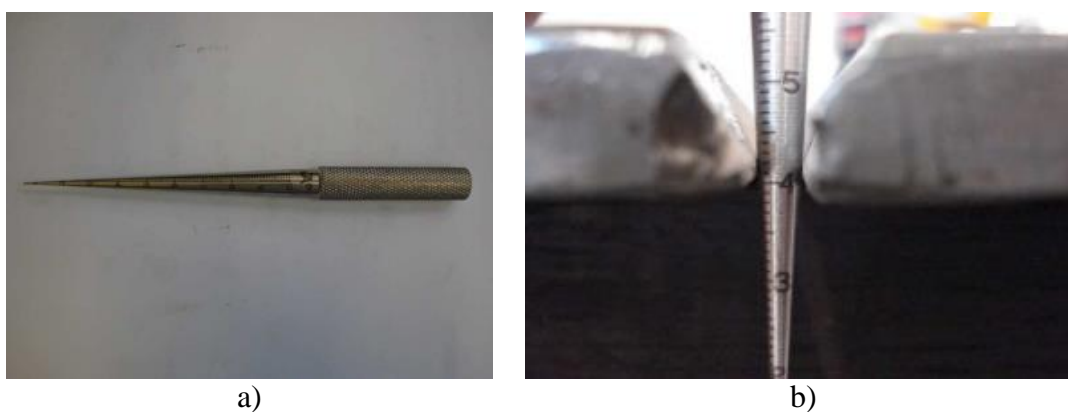
Slika 28. Mjerilo za mjerenje razmaka [27]: a) mjerilo, b) pravilna primjena mjerila
