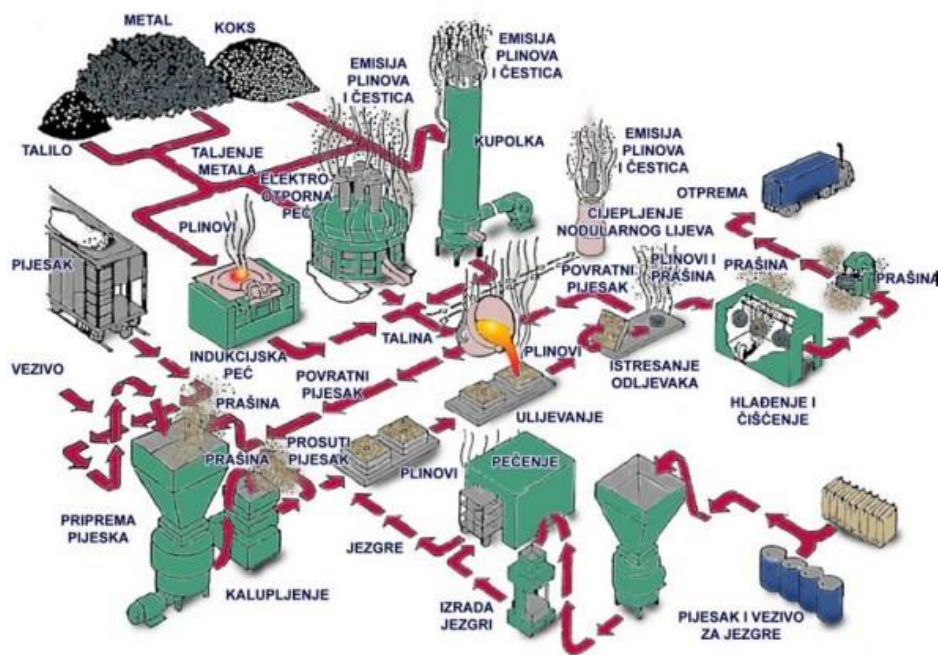
Slika 3. Shematski prikaz procesa u ljevaonicama [14]
