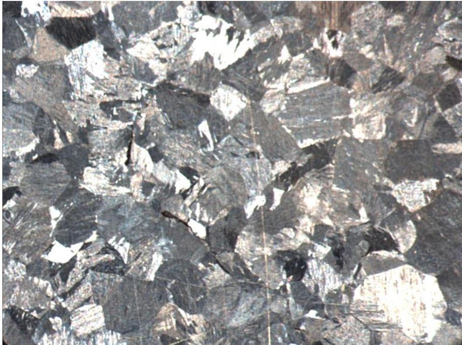
Slika 42. Svjetlosna mikroskopija uzorka 2 (870 °C/20'/vode) nakon nagrizanja
