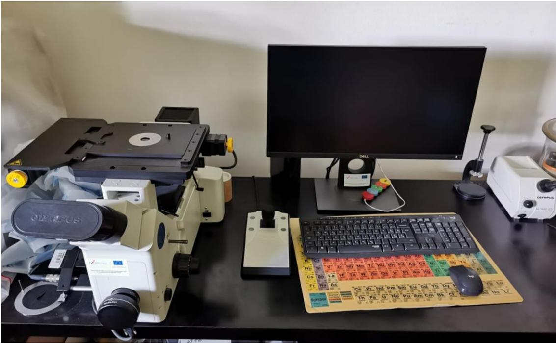
Slika 32. Fotografski snimak svjetlosnog mikroskopa Olympus GX51
