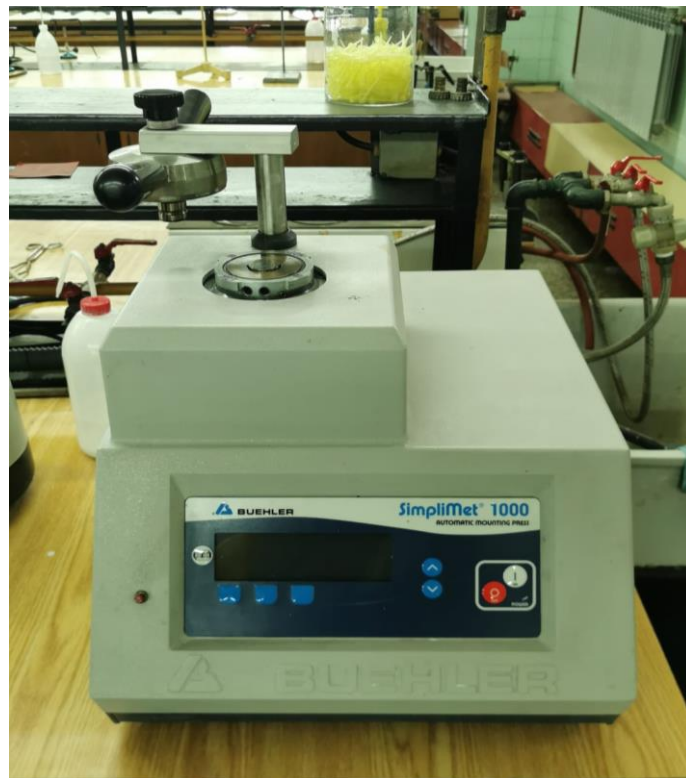
Slika 30. Fotografski snimak uređaja za vruće prešanje, Buehler Simplimet 1000
