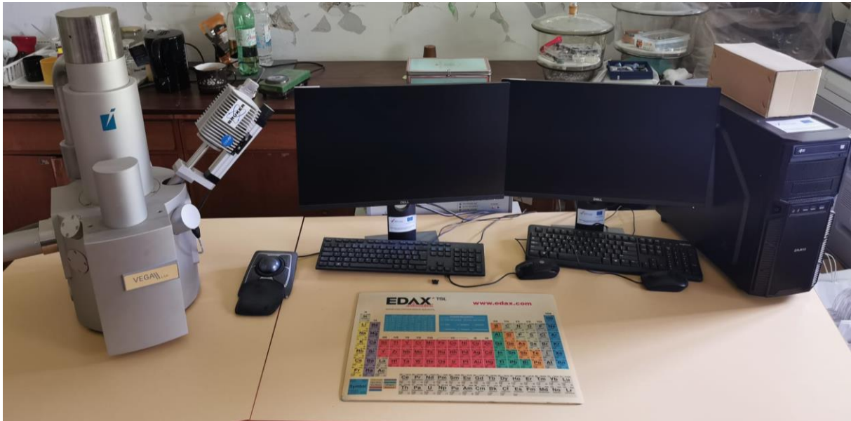
Slika 33. Fotografski snimak pretražnog elektronskog mikroskopa, TESCAN VEGA 5136
