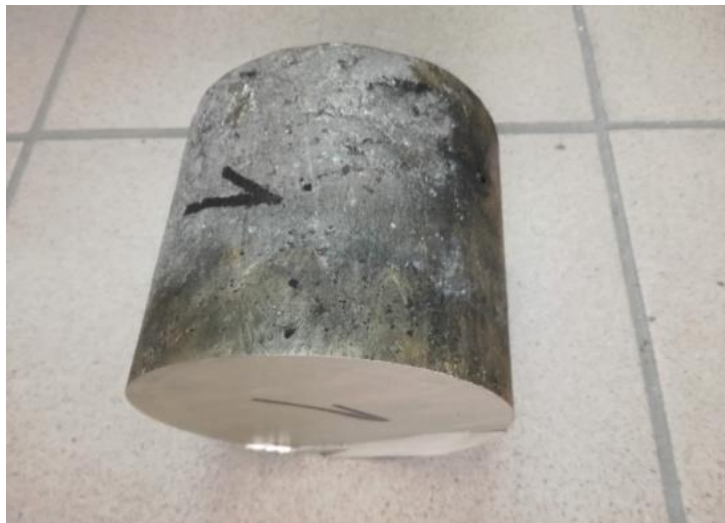
Slika 27. Fotografski snimak ingota CuAlMn legure
